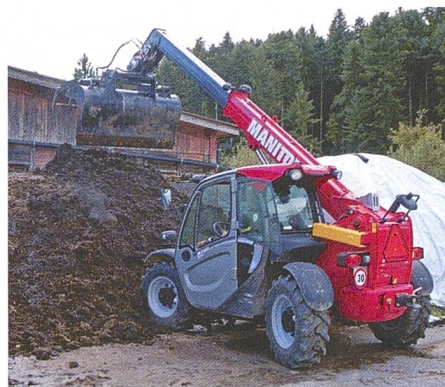
Voluminöse Schaufel, hohe Nutzlast, viel Reichweite und grosse Wendigkeit erleichtern die Handhabung des Komposts
