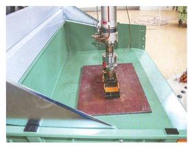
Mit dem Messzylinder in der Mitte der Ladefläche wurde die Kippkraftmessung durchgeführt.
