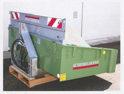
Europaletten in Längsrichtung zu verladen. Beim Ladevolumen liegt die «Profi Plus» mit 1,2 m³ im Mittelfeld. Aufsatzwände gibt es optional. Für den Scheitholztransport gibt es optional vier Steckrungen für die Seitenwände und zwei für die Stirnwand. Bei der praktischen Bewertung rangiert Scheibelhofer sowohl bei der Ausstattung als auch bei der praktischen Anwendung im guten Mittelfeld. Beim Schotterladen landete Scheibelhofer ex aequo mit Rosensteiner auf dem zweiten Platz.
