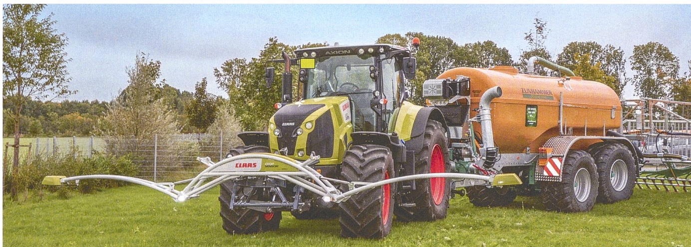
Zum teilflächenspezifischen Düngen mit flüssigem Hofdünger bietet sich neu die Kombination von Güllefass mit Nährstoffsensor und Pflanzensensor an. Bilder: R. Hunger
