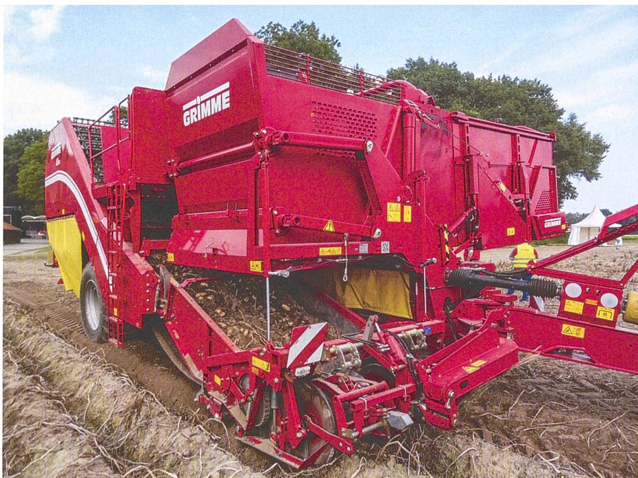
Der zweireihige Kartoffelroder «EVO 290», hier ein Prototyp, kommt mit neuem Design und 9-t-Bunker auf den Markt. Bilder: R. Engeler
