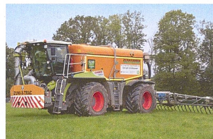
Mit Güllepower im Feld – der «Zuni-X-Trac» ist ein Selbstfahrer auf Basis des Claas «Xerion».
