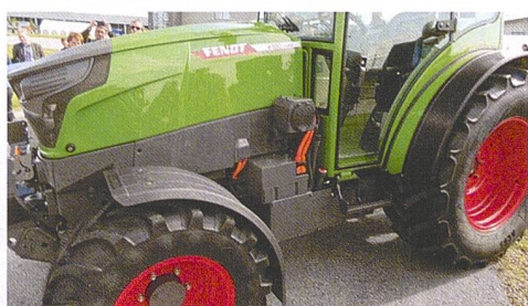
Soll bei üblicher Nutzung einen vollen Arbeitstag ohne Nachladen einsetzbar sein: Der batterieelektrische Fendt «e100 Vario».
