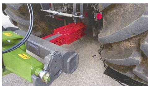
«VarioPull»: Durch einen hydromechanischen Verriegelungszylinder werden Anhängerkupplung oder Unterlenker bis zu 800 mm näher an die Hinterachse herangezogen.
