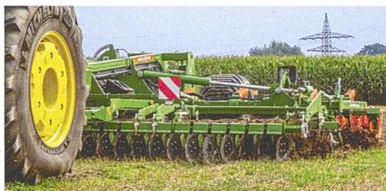
«Ceus» ist eine flexible Kombination von Kompaktscheibeneggen für die flache mit einem Zinkenfeld für die tiefe Bearbeitung bis zu 30 cm.
