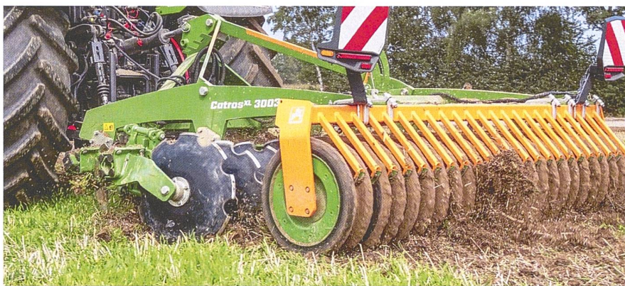
«Catros XL» nennt Amazone seine neue Scheibenegge mit grob oder fein gezackten, 610 mm grossen Scheiben. Bilder: R. Engeler
