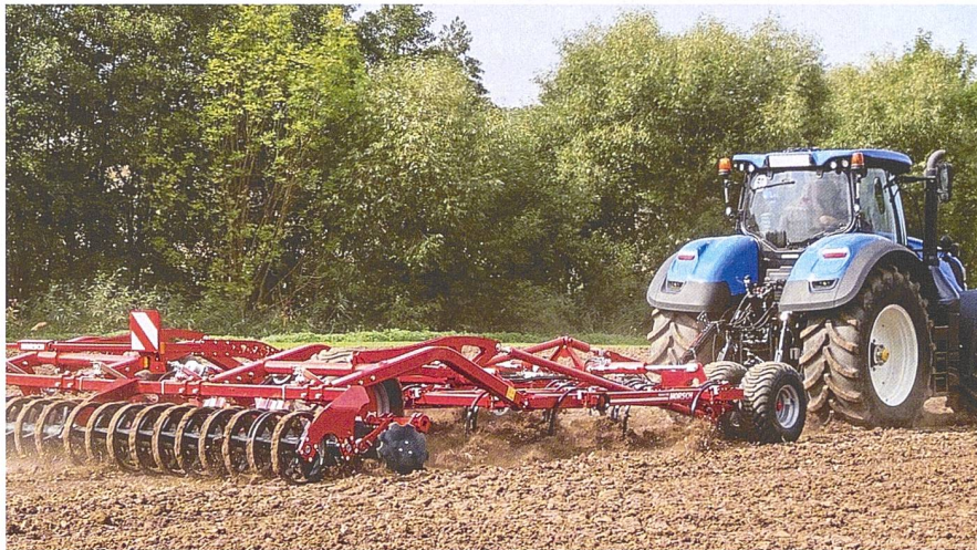
Der Feingrubber «Cruiser 5 XL» ist mit neuen Federzinken ausgestattet, die mehr Durchgang für das organische Material bieten sollen. Bilder: R. Engeler, zvg
