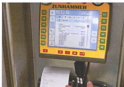
Der interne Belegdrucker ist eine neue Form der Dokumentation, weitere Möglichkeiten sind Datenträger oder drahtlose Übertragung (WLAN, Bluetooth).
