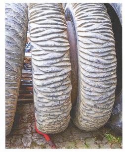
«Handgeschnitzt»: Die Doppelräder greifen beim Tractor Pulling hervorragend.
