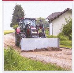
Räumschilde mit Polyurethanleiste schonen die Boden- bzw. Strassenoberfläche. Die Bodenanpassung ist verhältnismässig bescheiden. Grössere und festgefahrene Schmutzmengen können gut entfernt werden. Bombierte (wölbende) Strassenabschnitte werden mit Räumschildern kaum sauber gereinigt.
