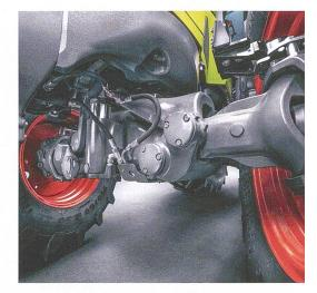
Eine Vorderachsfederung verbessert den Fahrkomfort, der Traktor neigt aber zu stärkerem Brems- und Anfahrnicken. Bild: Claas
