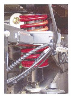
Durch eine Kabinenfederung werden Nickund Wankbewegungen reduziert. Bild: R. Hunger
