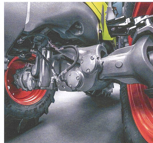
Eine Vorderachsfederung verbessert den Fahrkomfort, der Traktor neigt aber zu stärkerem Brems- und Anfahrnicken. Bild: Claas
