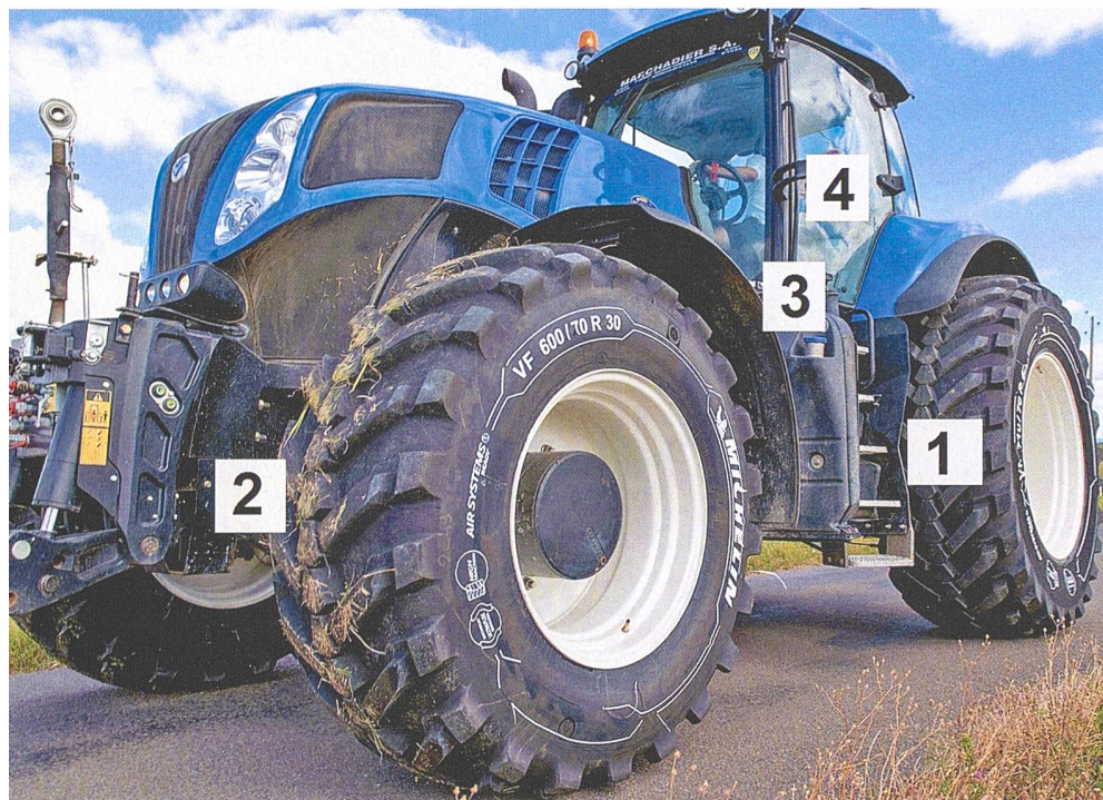
Reifen (1), Vorderachsfederung (2), Kabinenfederung (3) und Fahrersitz (4) sind bei einem modernen Traktor in ein komplettes Federsystem eingebunden. Bild: CNH
