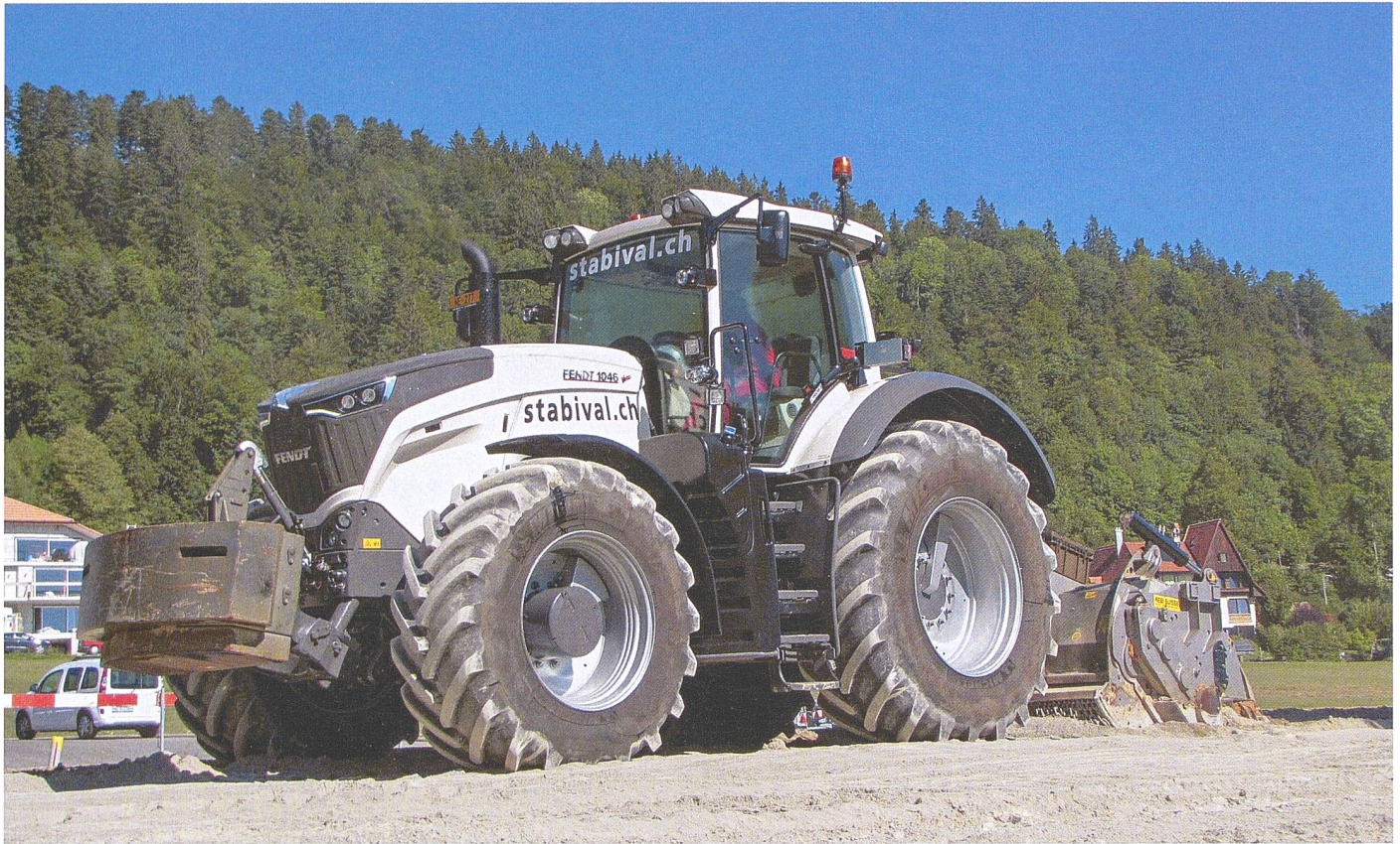
An der Anzahl der Aufstiegsstufen lässt sich die Grösse des «1046 Vario» erahnen. Der angehängte Steinbrecher arbeitet das Zementgemisch bis in eine Tiefe von über 30 cm ein. Ruedi Burkhalter
