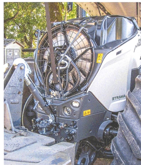
Der Hochleistungslüfter ist vor dem Kühlerpaket angebracht und drückt kalte Luft statt warme zu saugen.
