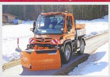
Vario-Schneepflüge besitzen zwei schwenkbare Pflugscharen, die über zwei Schwenkzylinder unabhängig voneinander betätigt werden können. Der Vario-Schneepflug kann variabel den momentanen Einsatzbedingungen angepasst werden. Folgende Konfigurationen sind möglich:
