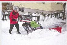
Die einfachsten Schneepflüge sind Stahlblechkonstruktionen, die meistens mechanisch in die Räumstellung (links, rechts, mittig) verstellt werden. Der Kontakt zur Räumfläche erfolgt über Stahl-, Gummi- oder Kunststoffschürfleisten. In aller Regel fehlt an diesen einfachen Schneepflügen eine Überfahrsicherung zum Schutz gegen Anfahren an Hindernisse (evtl. Scherbolzen). Schäden sind aufgrund geringer Geschwindigkeit selten.
