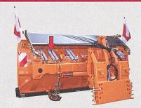
Es besteht die latente Gefahr, mit dem Schneepflug Hindernisse anzufahren. In Verbindung mit den nicht zu unterschätzenden Geschwindigkeiten kann es zu hohen Spitzenbelastungen einzelner Bauteile kommen. Die Hersteller sichern Schneepflüge mit Zug- oder Druckfedern, elastischen Gummielementen oder Gummipuffern. Nach dem Ansprechen einer Überlastsicherung kehrt der Schneepflug wieder in seine Arbeitsstellung zurück.
