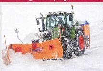
Der Schneepflug besteht aus mehreren (1–3) Einzelpflugscharen, die beim Anfahren an Hindernisse über eine Lenkerführung nach oben/hinten ausweichen können. Jede Pflugschar trägt eine auswechselbare Schürfleiste, welche den Kontakt zur Strassenoberfläche herstellt. Die Auswurfrichtung wird stufenlos nach rechts oder links verstellt.
