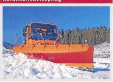
Einscharige Kunststoffschneepflüge eignen sich für den Winterdienst in tieferen Lagen, wo oft nasser Schnee und Schneematsch geräumt wird. Die mittragende Pflugschar ist schwingungsgedämpft in einen ebenso stabilen wie elastischen Stahlrahmen integriert. Der Pflug hat ein Druckfeder-Überlastsystem. Mit integrierter Schwimmstellung sind Räumgeschwindigkeiten bis 40 km/h möglich.
