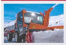
Transporter bieten dem Fahrer mit dem Frontanbau eine gute Übersicht. Vierradlenkung und Stufenlostechnologie verleihen dem Fahrzeug Beweglichkeit. Eingesetzt werden können Schneefräsen, Schneeschleudern, Schneefrässchleudern und Schneekehrbesen. Der Antrieb erfolgt über die Zapfwelle an der Transporterfront.
