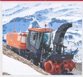
Selbstfahrer mit Motorleistungen bis 500 kW sind – abhängig von den Einsatzbedingungen – in der Lage, 4000 bis 6000t Schnee pro Stunde zu entfernen. Diese Maschinen sind mit einem Antriebsmotor, der Fahrantrieb und Räumkopf antreibt, ausgestattet. Während der Fahrantrieb hydrostatisch erfolgt, wird der Räumkopf mechanisch oder hydrostatisch angetrieben.
