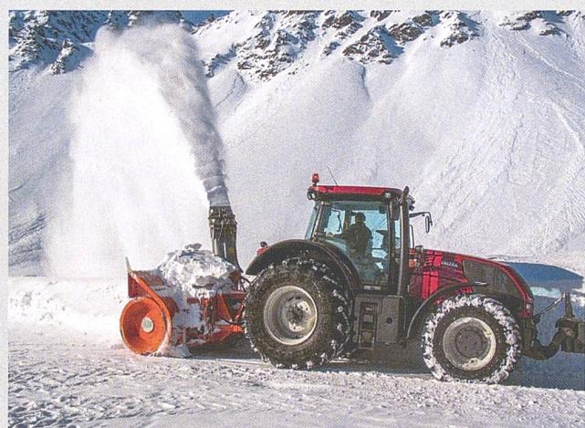
Mittels Rückfahrvorrichtung können am Heckanbauraum des Traktors auch grosse und schwere Schneeräumgeräte mit hoher Leistung eingesetzt werden, ohne die Vorderachse übermäßig zu beladen. Die Übersichtlichkeit für den Fahrer bleibt erhalten, und moderne Traktorgänge lassen in Rückwärts-Schubfahrt auch tiefe Fahrgeschwindigkeiten zu. Vorteilhaft ist der Anbau mittels genormter Aufnahmeplattform.
