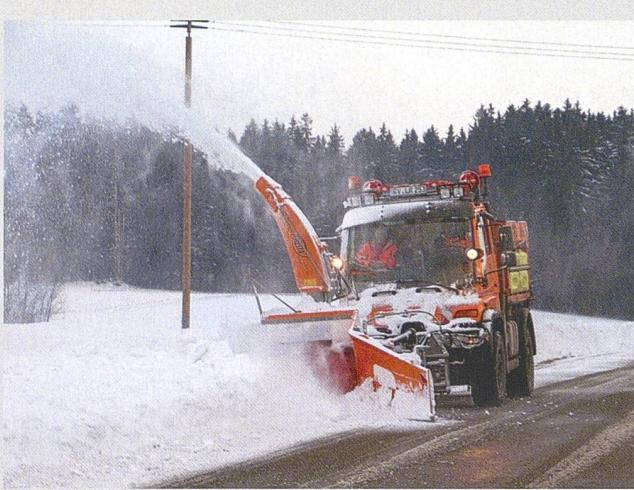
Einstufige Seitenfräse zum seitlichen Räumen eines Schneewalls, der durch den Einsatz des Schneepfluges entsteht. Der zusätzliche Zuführpflug schiebt Schneeresten zur Frästrommel. Für den Schneeeverlad auf LKW gibt es eine Schubstange mit Gummipuffer. Zudem kommen beim Verlad Verladekamine mit gezielter Schneestrahlführung zum Einsatz.
