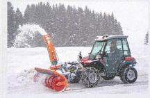
Zweiachsmäher werden für den Winterdienst mit Anbaugeräten aus dem kleineren bis mittleren Segment ausgerüstet. Stufenlostechnologie, Vierradantrieb und Vierradlenkung machen das Fahrzeug sehr flexibel. Der Anbau erfolgt praktisch ausschliesslich über das Dreipunktgestänge an der Front. Der Antrieb erfolgt über die Zapfwelle.
