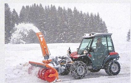
Zweiachsmäher werden für den Winterdienst mit Anbaugeräten aus dem kleineren bis mittleren Segment ausgerüstet. Stufenlostechologie, Vierradantrieb und Vierradlenkung machen das Fahrzeug sehr flexibel. Der Anbau erfolgt praktisch ausschliesslich über das Dreipunktgestänge an der Front. Der Antrieb erfolgt über die Zapfwelle.
