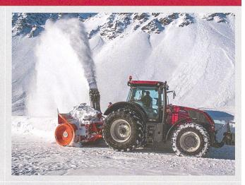
Mittels Rückfahrvorrichtung können am Heckanbauraum des Traktors auch grosse und schwere Schneeräumgeräte mit hoher Leistung eingesetzt werden, ohne die Vorderachse übermässig zu belasten. Die Übersichtlichkeit für den Fahrer bleibt erhalten, und moderne Traktorgetriebe lassen in Rückwärts-Schubfahrt auch tiefe Fahrgeschwindigkeiten zu. Vorteilhaft ist der Anbau mittels genormter Aufnahmeplattform.
