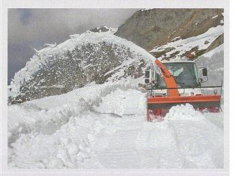
Diese zweistufigen Geräte werden zur universellen Schneeräumung eingesetzt. Es kann sowohl frisch gefallener, lockerer Schnee als auch alter verdichteter Schnee geräumt werden. Der Antrieb erfolgt über die Zapfwelle. Neben den einfachen Auswurfkaminen (Bild) kommen auch spezielle Verladekamine zum Einsatz. Die Schürfleisten sind aus verschleissbeständigem Stahl.
