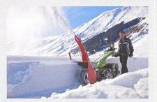
Die Geräte, die an Einachser angebaut werden können, sind als zweistufiges Arbeitsgerät konzipiert. Als erste Stufe wird die waagrecht und quer zur Fahrrichtung liegende Frästrommel bezeichnet, sie fräst den Schnee ab und führt ihn der zweiten Stufe zu. Die zweite Stufe ist das Schleuderrad, welches den Schnee übernimmt, beschleunigt und über eine Auswurfvorrichtung auswirft.
