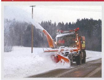
Einstufige Seitenfräse zum seitlichen Räumen eines Schneewalls, der durch den Einsatz des Schneepfluges entsteht. Der zusätzliche Zuführpflug schiebt Schneeresten zur Frästrommel. Für den Schneeverlad auf LKW gibt es eine Schubstange mit Gummipuffer. Zudem kommen beim Verlad Verladekamine mit gezielter Schneestrahlführung zum Einsatz.
