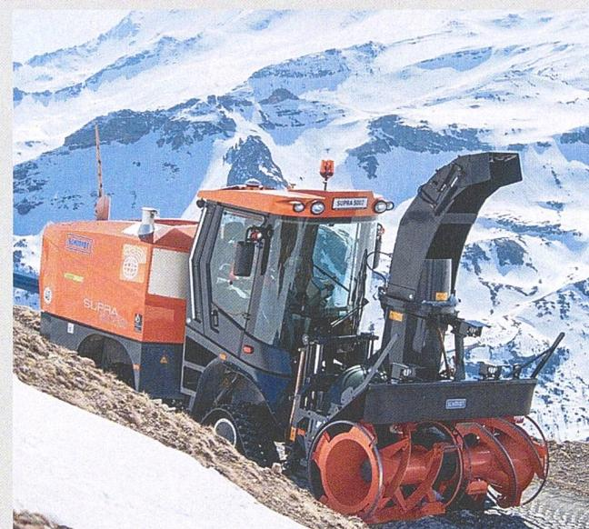
Selbstfahrer mit Motorleistungen bis 500 kW sind – abhängig von den Einsatzbedingungen – in der Lage, 4000 bis 6000t Schnee pro Stunde zu entfernen. Diese Maschinen sind mit einem Antriebsmotor, der Fahrantrieb und Räumkopf antreibt, ausgestattet. Während der Fahrantrieb hydrostatisch erfolgt, wird der Räumkopf mechanisch oder hydrostatisch angetrieben.
