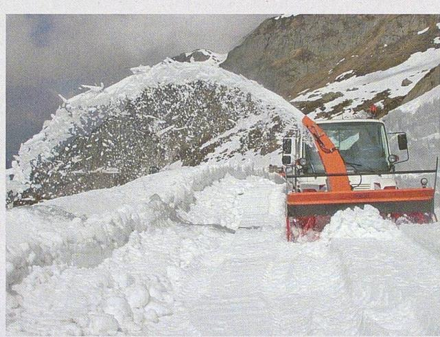
Diese zweistufigen Geräte werden zur universellen Schneeräumung eingesetzt. Es kann sowohl frisch gefallener, lockerer Schnee als auch alter verdichteter Schnee geräumt werden. Der Antrieb erfolgt über die Zapfwellen. Neben den einfachen Auswurfkaminen (Bild) kommen auch spezielle Verladekamine zum Einsatz. Die Schürfleisten sind aus verschleissbeständigem Stahl.
