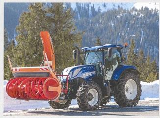
Der Frontanbauraum eignet sich gut für den Anbau von Schneefrässchleudern. Allerdings muss die erlaubte Vorderachsbelastung berücksichtigt werden. Betreffend Frontanbau gelten die Strassenverkehrsvorschriften nach VRV Art. 64 Abs.3 und VTS Art. 28a. Der Traktor muss mit einem Getriebe ausgerüstet sein, das geringe Fahrgeschwindigkeiten ermöglicht.
