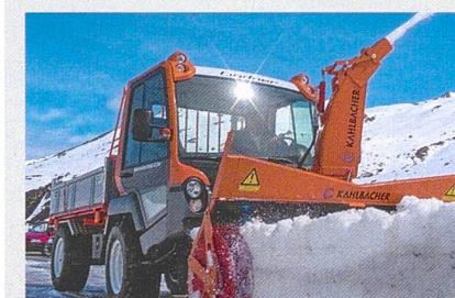
Transporter bieten dem Fahrer mit dem Frontanbau eine gute Übersicht. Vierradlenkung und Stufenlostechologie verleihen dem Fahrzeug Beweglichkeit. Eingesetzt werden können Schneefräsen, Schneeschleudern, Schneefrässchleudern und Schneekehrbesen. Der Antrieb erfolgt über die Zapfwelle an der Transporterfront.
