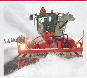
Radlader haben oft keine genügend grosse Hydraulikleistung. Deshalb gibt es für sie autonome Schneefrässchleudern, die mit wenigen Handgriffen von einer Person an den hydraulisch verriegelbaren Radlader-Schnellanschluss angehängt werden können. Auch diese Aggregate sind nach dem Zweistufensystem mit Fräshaspel und Schleuderrad gebaut. Motorleistung ab 80 kW (Zaugg).
