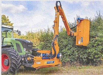
Das Öl für alle hydraulischen Bauteile stammt üblicherweise aus der bordeigenen Hydraulikversorgung. Damit ist gewährleistet, dass die ganze Hydraulikanlage auf die Bedürfnisse des Geräts ausgelegt ist. Dies einschliesslich eines darauf abgestimmten Kühlsystems, das die Wärmeentwicklung verringert. Der Kühler wird hydraulisch (oder elektrisch) angetrieben. Optional gibt es eine elektrische Rotorsteuerung.
