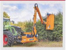
Neben der bordeigenen Hydraulikversorgung gibt es die Möglichkeit, dass die Versorgung über die Leistungshydraulik des Trägerfahrzeuges sichergestellt wird.
