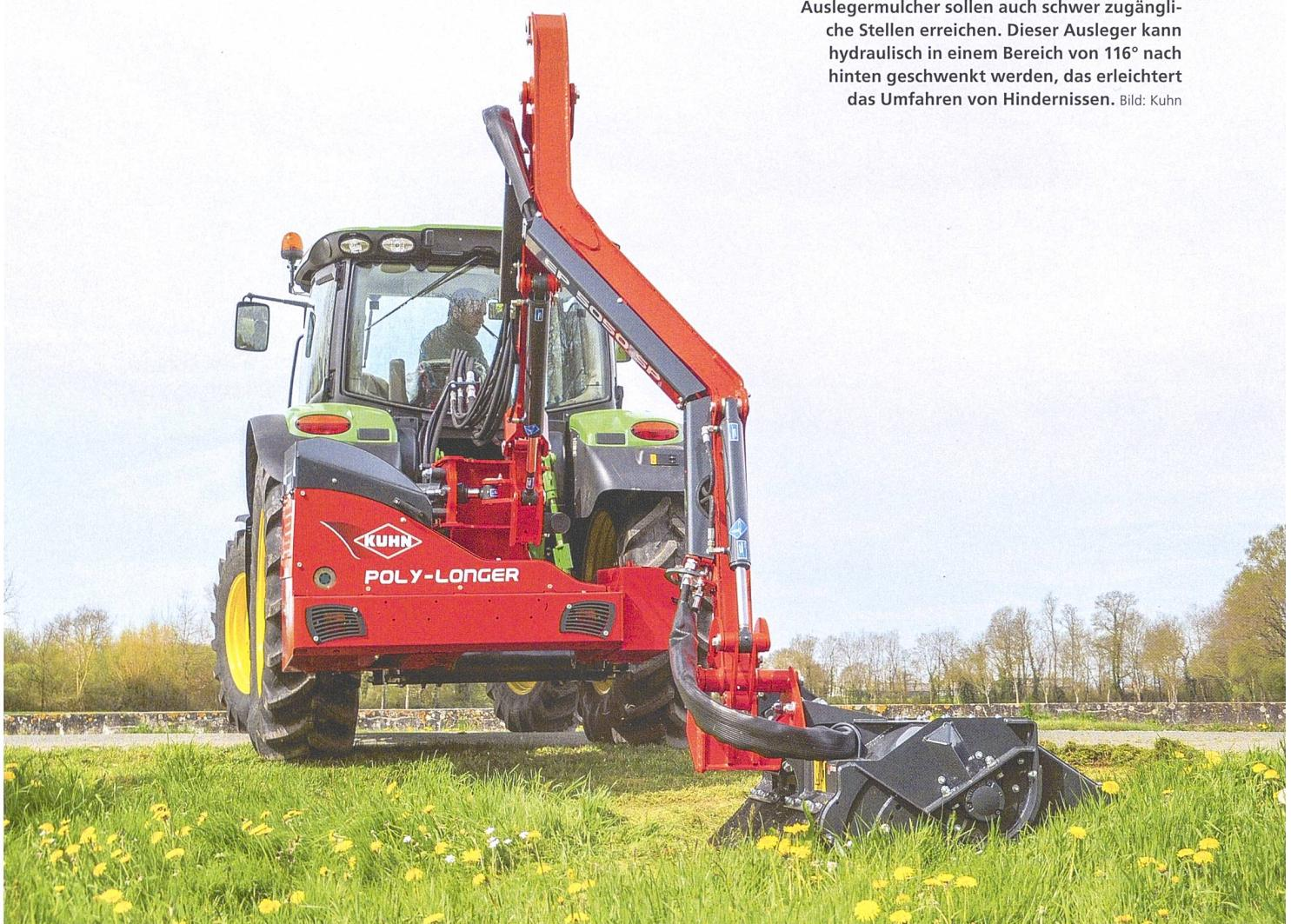
Auslegermulcher sollen auch schwer zugängliche Stellen erreichen. Dieser Ausleger kann hydraulisch in einem Bereich von 116° nach hinten geschwenkt werden, das erleichtert das Umfahren von Hindernissen. Bild: Kuhn
