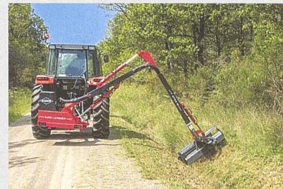
Der Frontanbau ist insbesondere für kommunale Arbeiten der bevorzugte Anbauraum. Er bietet dem Fahrer eine gute Übersicht und sichert eine ergonomisch günstige Bedienung des Geräts. Bei Traktoren können nicht zu unterschätzende Torsionskräfte auftreten, die konstruktionsmäßig in den Block eingeleitet werden müssen (Bild Stegemann/Dücker Kommunalrahmen).
