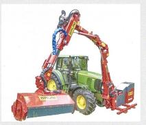
Der Frontanbau bringt zwar eine hohe Belastung der Traktorvorderachse mit sich, sichert dem Fahrer aber beste Übersicht. Im Bild die schwere Ausführung eines dreiteiligen Auslegers mit Teleskoparm. Zur besseren Gewichtsverteilung bieten einzelne Hersteller die aufgelöste Bauweise mit dem Hydrauliktank an der Heckhydraulik an.
