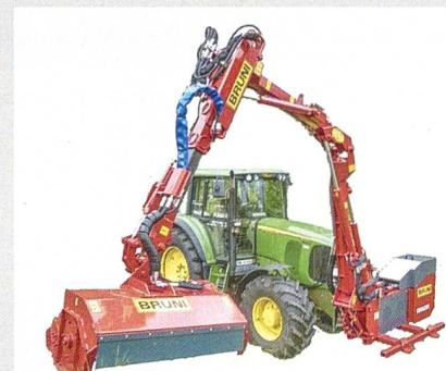
Bei Heckanbaugeräten setzen sich bei vielen Herstellern jene Modelle für den professionellen Anwendungsbereich durch, die einen nach vorne abgewinkelten Ausleger aufweisen. Durch den Versatz von rund einem Meter, gemessen von den Unterlenker-Fangkugeln bis zur Rotormitte, verbessern sich die Sichtfreiheit und damit der Arbeitskomfort.
