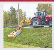
Wenn Böschungen ausschliesslich im traktornahen Bereich gemäht bzw. gemulcht werden, bieten sich kurze Auslegerarme an. Diese Bauart ermöglicht (noch) den mechanischen Antrieb mittels Keilriemen. Im Bild ein Horizontal-Mulchgerät.
