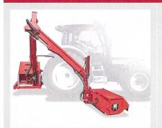
Bei Heckanbaugeräten setzen sich bei vielen Herstellern jene Modelle für den professionellen Anwendungsbereich durch, die einen nach vorne abgewinkelten Ausleger aufweisen. Durch den Versatz von rund einem Meter, gemessen von den Unterlenker-Fangkugeln bis zur Rotormitte, verbessern sich die Sichtfreiheit und damit der Arbeitskomfort.
