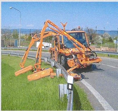
Hydraulisch angetriebener Mulchkopf. Getragen wird er vom Ausleger im Frontanbau und von Schieberahmen. Als Trägerfahrzeug dient ein Spezialfahrzeug (Transporter mit Semi-Hydrostat). Die Sitzposition entscheidet über den Sichtbereich des Fahrers.
