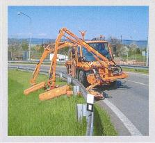
Anspruchsvoll für Fahrer, Bedienpersonen und Trägerfahrzeuge: Eine Dreierkombination unter Nutzung von verschiedenen An- und Aufbauräumen ist eigentlich nur mit Spezialfahrzeugen wie beispielsweise einem Unimog einsetzbar.
