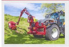
Der Frontanbau ist insbesondere für kommunale Arbeiten der bevorzugte Anbauraum. Er bietet dem Fahrer eine gute Übersicht und sichert eine ergonomisch günstige Bedienung des Geräts. Bei Traktoren können nicht zu unterschätzende Torsionskräfte auftreten, die konstruktionsmässig in den Block eingeleitet werden müssen (Bild Stegemann/Dücker Kommunalrahmen).
