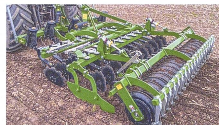
Ein vorlaufendes Crossboard, aggressive Scheiben und eine Schnittwinkelverstellung von 0 bis 25° zeichnen die «X-Press VX» von Great Plains (Simba) aus. Bild: Great Plains
