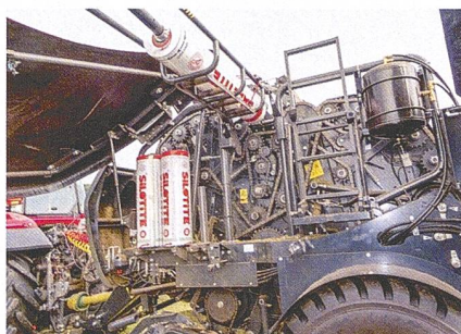
Bei der Nonstop-Rundballenpresse «FastBale» kann nun zwischen Netz- und Folienbindung gewechselt werden.
