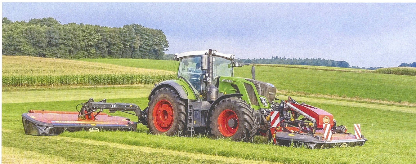
Kverneland/Vicon setzen die Technik der GPS-basierten Teilflächenbewirtschaftung oder «Section Control» nun auch bei der Futterernte-technik ein – hier beim Schmetterlingsmäherwerk «Extra 7100 T». Bilder: R. Engeler
