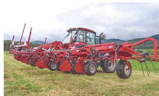
Aushub-Kinematik beim Kreiselheuer «GF 1018»: Alle Kreisel werden gleichzeitig auf die gleiche Höhe ausgehoben.
