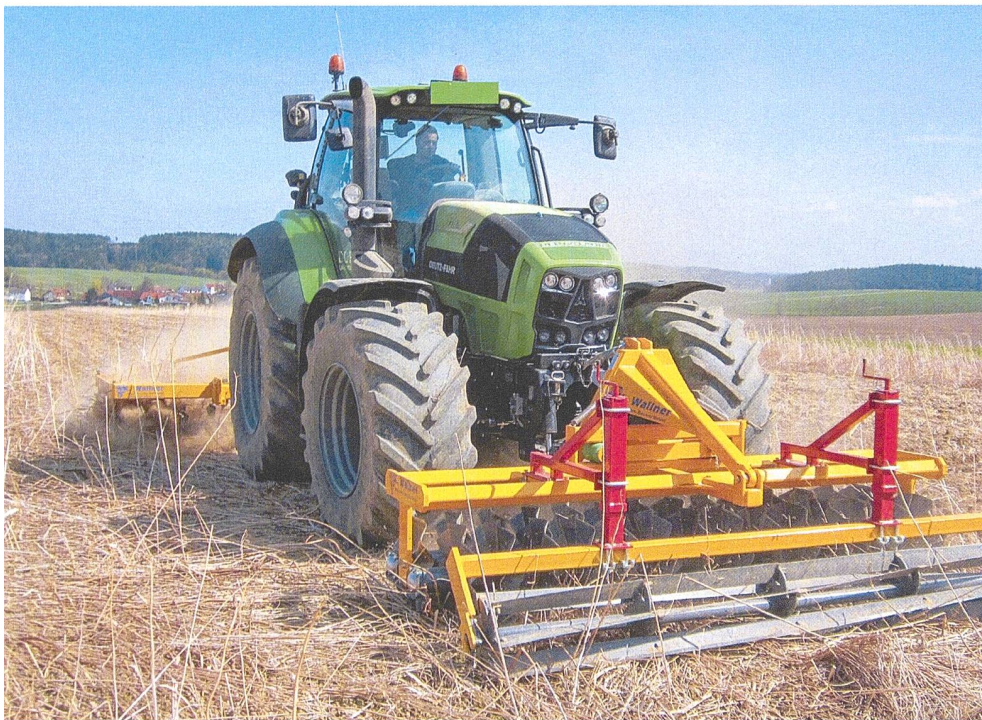
Die doppelte Kombination aus Messerwalze und Doppelwellscheibenpacker arbeitet besonders intensiv. Hier in einem abgeernteten Zwischenfruchtbestand. Bild: K. Wallner Maschinenbau
