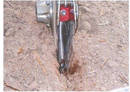
Die Einzelkornsäat mit «Optima» kann mit Flüssigdüngung aus einem Fronttank kombiniert werden.
