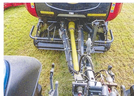
Eine hydraulisch automatisierte Deichselsteuerung erleichtert bei ungleichmässigen Schwaden die Arbeit mit der Ballenpresse.
