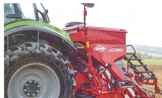
«Venta 3020 HR»: Pneumatische Säkombination mit Kreiselegge und Doppelscheibenschar. Nahezu alle Einstellungen lassen sich vom Traktor aus erledigen.
