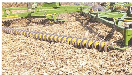
Kettenscheibeneggen eignen sich für Silomaisstoppeln; mit grossen Mengen Körnermaisstroh sind sie überfordert.
