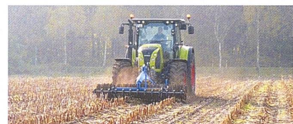
Bereits mit einer «CamCross»-Walze können Maisstoppeln zur Zünslerbekämpfung bearbeitet werden, für Fusariosen reicht es aber nicht aus. Bild: Tigges
