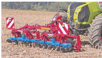
Der «Zünslerschreck-Aktiv» von Knoche, ergänzt durch das aktive Reibradsystem der Firma Bass Antriebstechnik. Bild: Knoche
