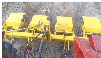
Die «Maisstoppelwalze» von IK Maschinenbau spaltet die Stoppeln in Längsrichtung bis zur Wurzel. Bild: IK-Maschinenbau
