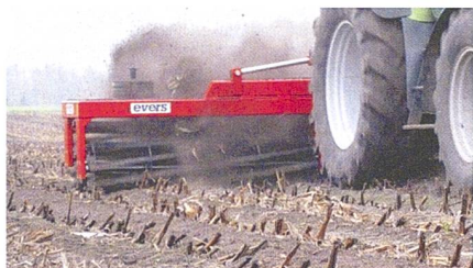
Doppelmesserwalzen halbieren den Messerabstand. Im Bild die «Furioso» von Evers-Agro. Bild: Evers-Agro
