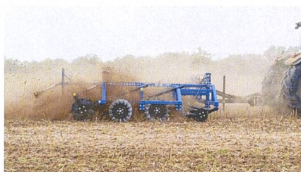
Die klappbare «Hektor Gigant» mit einer durchgehenden und mehreren segmentierten Messerwalzen hat pro Meter Arbeitsbreite 55 Messer. Bild: IAT-Agrar
