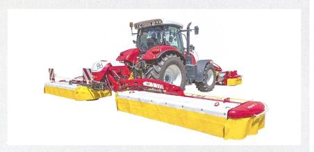
Mit «Novacat A9» erweitert Pöttinger seine Palette der Schmetterlingsmähwerke. Die Kombination, bestehend aus 3,0 oder 3,5 m breitem Frontmähwerk und Heckeinheit, weist eine Arbeitsbreite von 8,92 oder 9,18 m auf, die über zwei Absteckpositionen entsprechend angepasst werden kann. Die Maschine verfügt über einen stabi-
