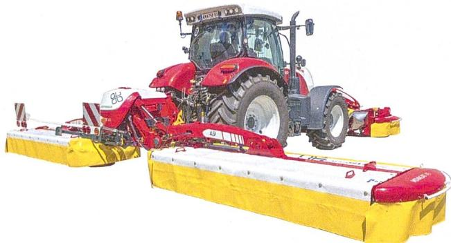
Mit «Novacat A9» erweitert Pöttinger seine Palette der Schmetterlingsmähwerke. Die Kombination, bestehend aus 3,0 oder 3,5 m breitem Frontmähwerk und Heckeinheit, weist eine Arbeitsbreite von 8,92 oder 9,18 m auf, die über zwei Absteckpositionen entsprechend angepasst werden kann. Die Maschine verfügt über einen stabi-
