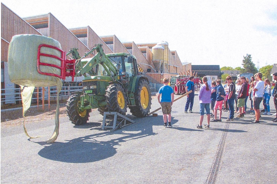
Eindrucksvoll demonstrieren die beiden Kursleiter Stephan Berger und Hans Burri die Folgen einer Fehleinschätzung in einem simulierten unebenen Gelände mit einer Frontlast auf.
