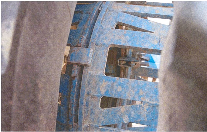
Das Doppelradsystem Somac französischer Provenienz von aussen...
