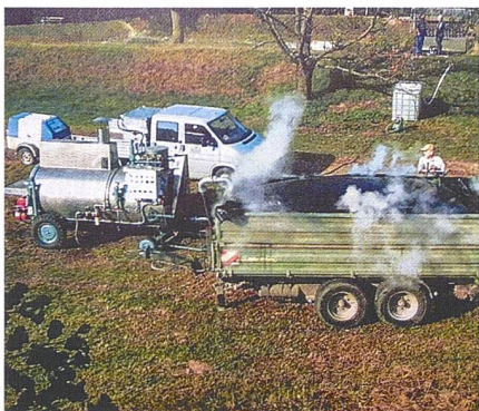
Anhängerdämpfung: Das Anhängerdämpfen kann unmittelbar vor Ort durchgeführt werden. Ein hofeigener Anhänger wird entsprechend ausgerüstet.
