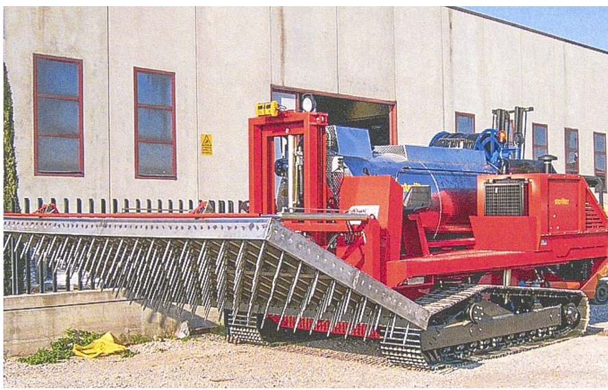
Injektordämpfung: Über die Stechzylinder wird Dampf mit einer Temperatur von 80 bis 90°C in den Boden eingeleitet.
