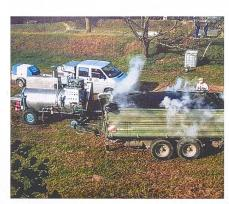
Anhängerdämpfung: Das Anhängerdämpfen kann unmittelbar vor Ort durchgeführt werden. Ein hofeigener Anhänger wird entsprechend ausgerüstet.
