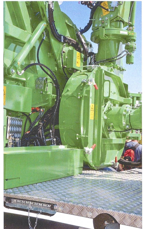
Ein hydraulisch angetriebenes Förderaggregat übernimmt die zuverlässige Schnitzelförderung. Bild: R. Hunger
