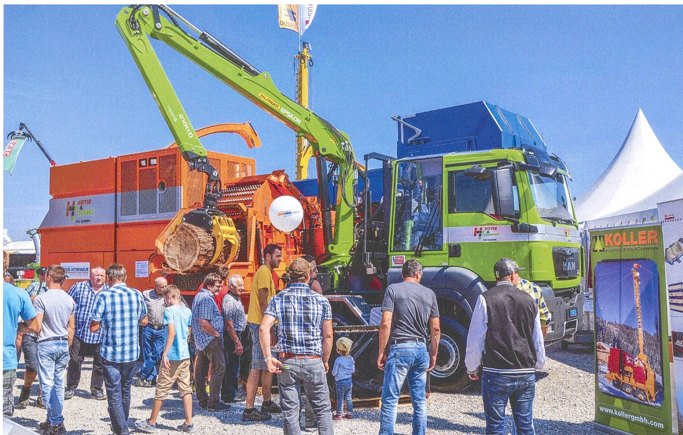
Trommelhäcksler beanspruchen verhältnismässig wenig Platz und eignen sich daher gut für den mobilen Einsatz. Bild: R. Hunger
