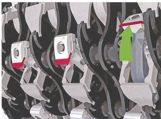
Beim Rotor mit «Störstoffsicherung» von Komptech klappt die ganze Messeraufnahme nach hinten weg, wenn sie auf einen Fremdkörper trifft. Bild: Komptech
