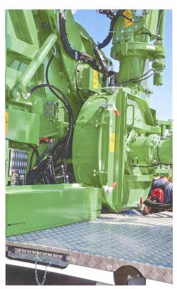
Ein hydraulisch angetriebenes Förderaggregat übernimmt die zuverlässige Schnitzelförderung. Bild: R. Hunger
