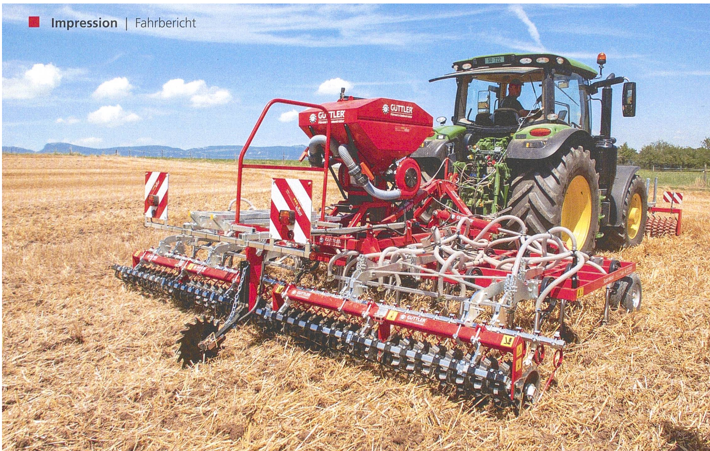
Grundbodenbearbeitung, Unkrautbekämpfung, Saatbettbereitung, Breit- und Reihensaat: Die Federzahnegge «SuperMaxx» von Guttler ist vielseitig einsetzbar. Bilder: H. Röthlisberger
