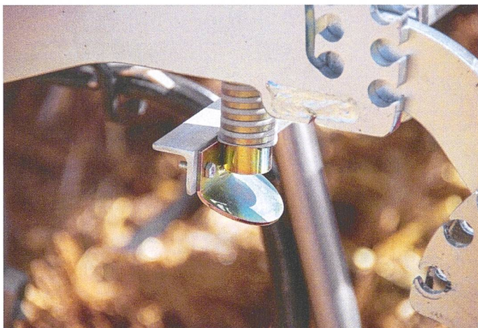
Die Breitsaat erfolgt über acht einstellbare Pralldüsen vor dem Striegel und der Nachläuferwalze.
