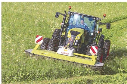
Trommelmähwerke mähen unter allen Bedingungen und legen das Futter zu einem schmalen Schwad zusammen.
