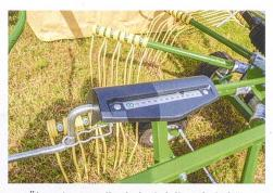
Über eine Handkurbel wird die Arbeitshöhe – angezeigt auf einer Skala – eingestellt.
