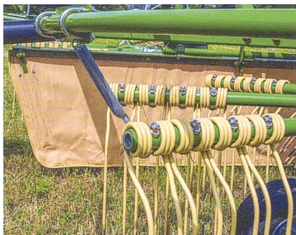
Standmässig sind pro Zinkenarm drei Zinken verbaut, es gibt aber Platz für eine vierte.
