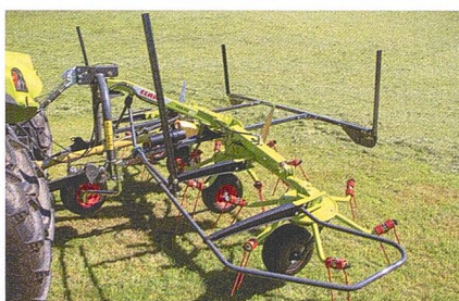
Zwei Feder-Stabilisatoren zentrieren die Zetter beim Ausheben automatisch in die Mittelstellung.
