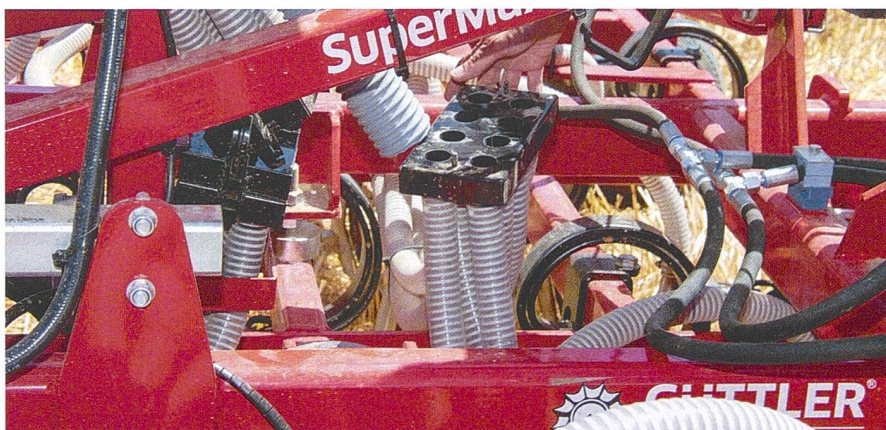
Mit einem Bajonettverschluss können die Schläuche von der Breit- zur Reihensaat umgehängt werden.
