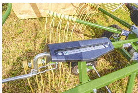
Über eine Handkurbel wird die Arbeitshöhe – angezeigt auf einer Skala – eingestellt.
