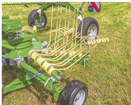
Pro Kreisel können zwei Zinkenarme optional eingeklappt werden. Die Transporthöhe ...
