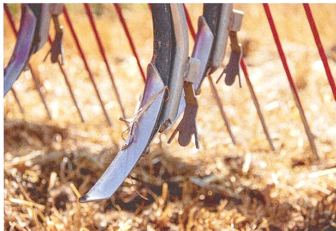
Schweizer Innovation: Reihensaat bei jeder Schar via Chromstahlrohr und zusätzliche Schläuche.
