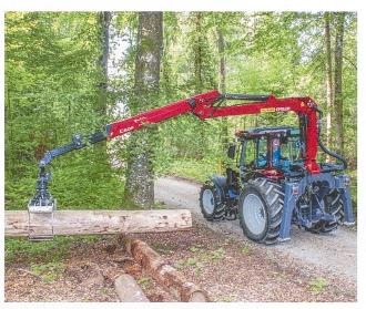
Der Palfinger «C60F86» hat eine Reichweite von 8,6 Meter. Die Seilwinde war beim Fototermin im Service, deshalb ist sie hier nicht mit auf dem Bild.
