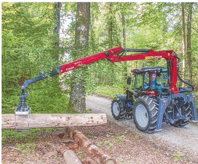
Der Palfinger «C60F86» hat eine Reichweite von 8,6 Meter. Die Seilwinde war beim Fototermin im Service, deshalb ist sie hier nicht mit auf dem Bild.
