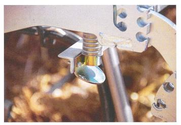
Die Breitsaat erfolgt über acht einstellbare Pralldüsen vor dem Striegel und der Nachläuferwalze.
