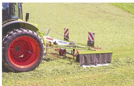
Der Schwader «Liner 320» eignet sich für kleine Flächen und kommt im schwierigen Gelände gut zurecht.
