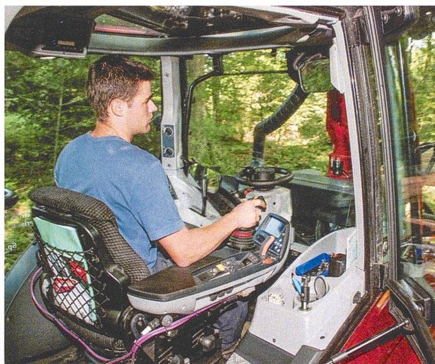
Praktische Rückfahreinrichtung: Für den Kraneinsatz wird der Sitz um 180° gedreht. Die Kransteuerung erfolgt mit zwei Joysticks, mit denen auch der Traktor gelenkt und gefahren werden kann.
