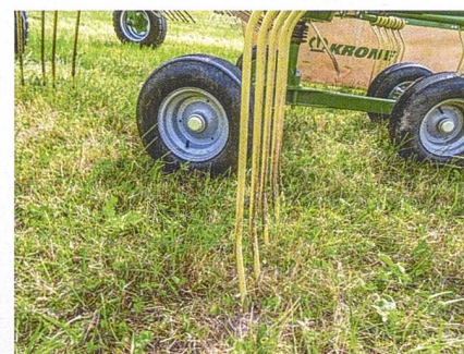
Die «Lift-Zinken» weisen im unteren Teil eine zusätzliche Kröpfung auf.
