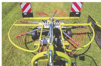
Wie die grossen Schwader von Claas hat auch dieses Einstiegsmodell eine geschlossene, dauergeschmierte Kurvenbahn.
