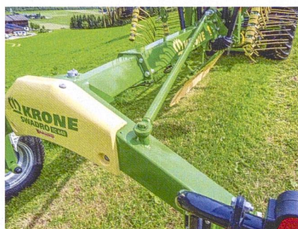
Auf Wunsch gibt es eine Achs-Schemellenkung für das Transportfahrwerk.
