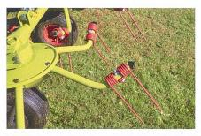
Die Zinkenarme sind gegen die Drehrichtung geknickt. Das erlaubt laut Claas eine um 1 bis 2 km/h höhere Arbeitsgeschwindigkeit.
