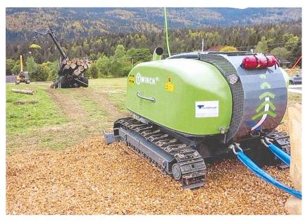
Einen anderen Weg geht Ecoforst: Der externen Traktionswinde wird ein eigenes Fahrwerk verpasst. Bild: Ecoforst
