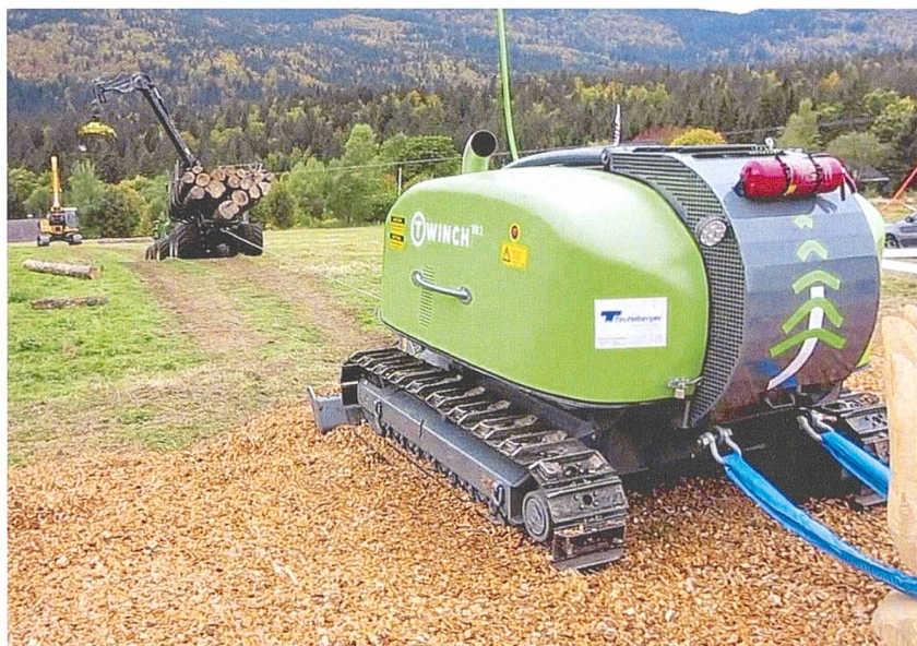
Einen anderen Weg geht Ecoforst: Der externen Traktionswinde wird ein eigenes Fahrwerk verpasst. Bild: Ecoforst
