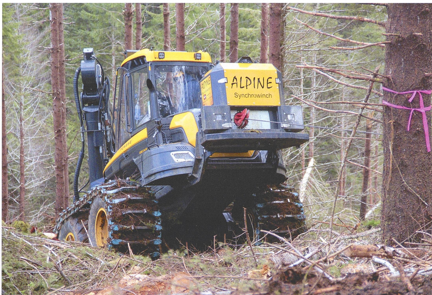
Aufgebaute Synchronwinden stehen immer und sofort zur Verfügung, belasten das Fahrzeug aber mit erheblichem Zusatzgewicht. Bild: Herzog
