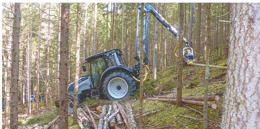
In jungen Beständen ist die Holzernte mit dem aufgebauten Harvesterprozessor produktiver als der Einsatz der Motorsäge.
