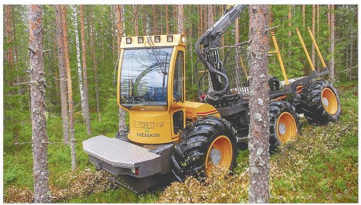
Beim elektrischen Hybridantrieb von «El Forest» werden Lithiumakkus als Energiespeicher genutzt. Bild: El Forest
