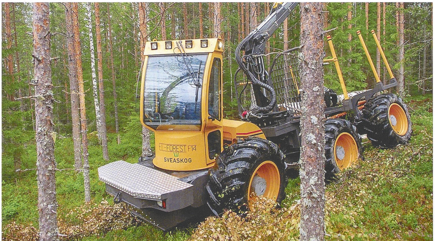
Beim elektrischen Hybridantrieb von «El Forest» werden Lithiumakkus als Energiespeicher genutzt. Bild: El Forest
