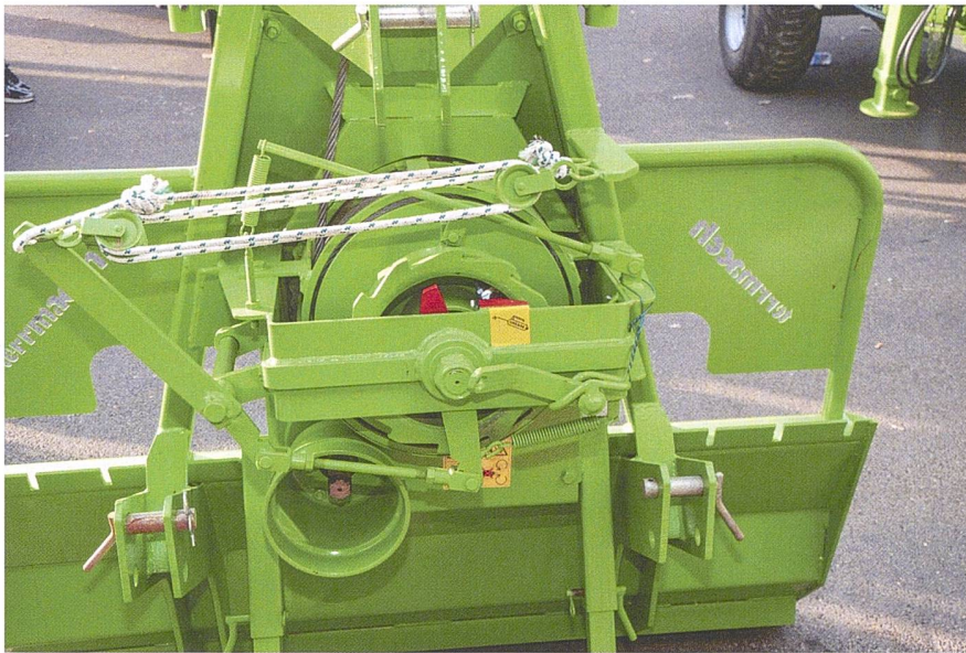
Einfache Seilwinden verfügen über eine manuelle Bedienung, mit dem Nachteil, dass sich die bedienende Person im relativen Gefahrenbereich befindet. Bild: R. Hunger
