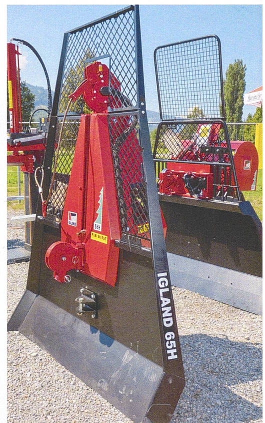
Die hydraulisch höhenverstellbare untere Umlenkrolle lässt sich über ein einfach wirkendes Steuergerät optimal einstellen.
