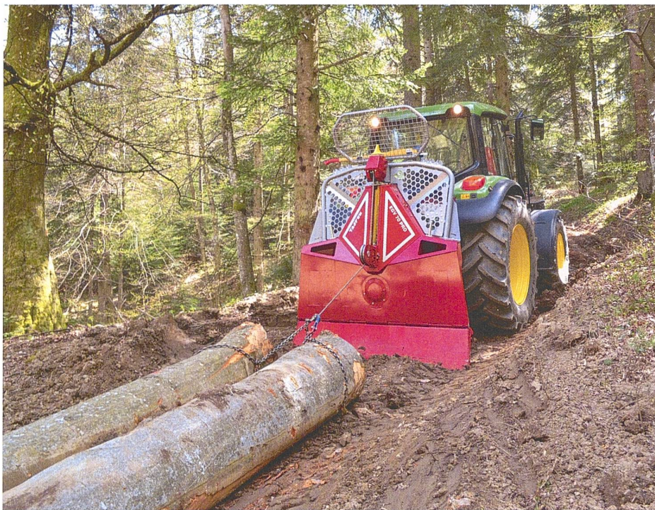
Wie gross soll die Forstwinde sein? So gross, dass sie die Anforderungen abdecken kann. Ob eine Tonne Zugkraft pro 10 kW Motorleistung richtig oder falsch ist, entscheidet das Einsatzspektrum. Bild: Unterreiner
