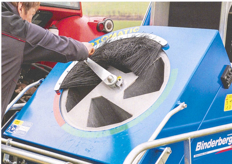
Binderberger «Rotomatic EZ»: stufenloses Verstellen der Schnittlängen mit einem Aufsteckschlüssel.
