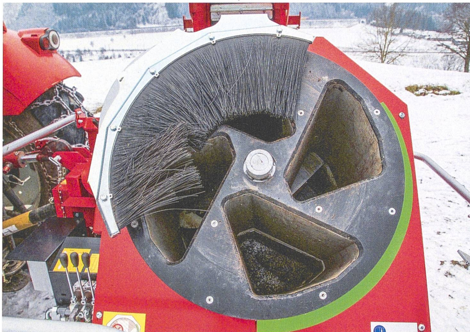
Unterreiner «Quatromat»: Trommel mit vier Schächten und stufenloser Geschwindigkeitsverstellung.
