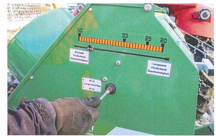
Hydraulische Schnittlängenverstellung mit grossem Verstellbereich.
