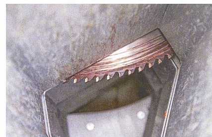
Kreissägeblatt: 120 Zähne, 5,2 mm stark, Durchmesser 700 mm.
