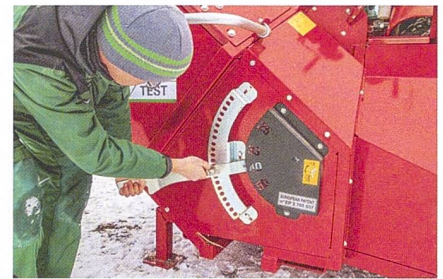
Werkzeuglose Schnittlängenverstellung in Stufen.
