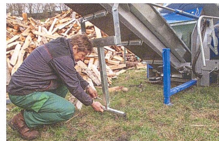
Abstellstützen stabilisieren das Gerät und das Förderband.
