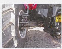
Bei den «Puma»-Modellen «185» bis «240» mit Powershift und stufenlosem Getriebe wird eine verbesserte Vorderachsfederung mit Doppeldruckspeicher verbaut, die mehr Federweg bietet und gleichzeitig eine Steigerung des zulässigen Gesamtgewichts auf 13 650 kg beim «Puma» bzw. 14 000 kg beim «Puma CVX» ermöglicht. Weiter ist die adaptive und reaktive Lenkung verfügbar, mit der die Lenkradumdrehungen und Einschlagswinkel der Vorderräder eingestellt
