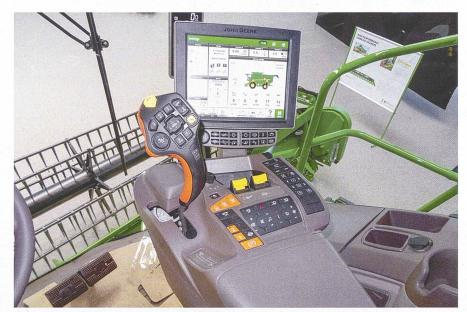
Mit neuem Bedienhebel und einem Bildschirm anlog heutiger Smartphone-Technik, vor allem aber dank neuen elektronischen Möglichkeiten soll die installierte Leistung einer Maschine besser genutzt werden können.
