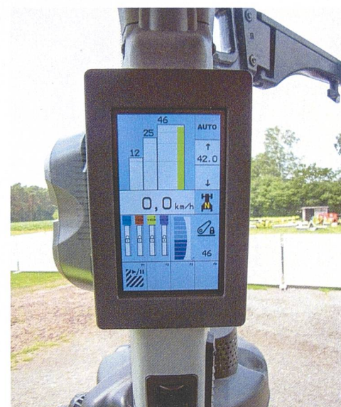
Das «Cis+»-Farbdisplay im A-Holm zeigt in der Standardansicht eine gute Übersicht der aktuellen Einstellungen der drei virtuellen Fahrbereiche.
