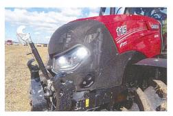
Fine neue Kühlerhaube mit mehr Ansaugfläche für die Kühlaggregate sowie neue Beleuchtungsoptionen mit individuell zuschaltbaren Halogen- oder auch LED-Schweinwerfern sind äussere Zeichen der neuen «Maxxum» Traktoren.
