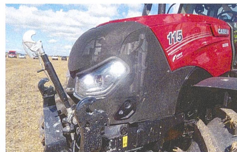
Eine neue Kühlerhaube mit mehr Ansaugfläche für die Kühlaggregate sowie neue Beleuchtungsoptionen mit individuell zuschaltbaren Halogen- oder auch LED-Schweinwerfern sind äussere Zeichen der neuen «Maxxum» Traktoren.
