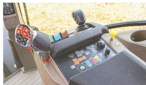
Das neue Doppelkupplungsgetriebe «ActiveDrive 8» bietet je 24 Vorwärts- und Rückwärtsgänge, die sich auch auf dem Steuergeräte-Kreuzhebel schalten lassen.
