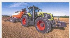
Die Grosstraktoren «Axion 900» werden auf Ende 2017 ebenfalls in einer neuen Generation mit stärkeren Motoren, Niedrigdrehzahlkonzept sowie mit den Ausstattungsvarianten «Cis+» und «Cebis» auf den Markt kommen. Die Maximalleistung reicht jetzt von 325 bis 445 PS beim Spitzenmodell «Axion 960». Durch das weiterentwickelte Niedrigdrehzahlkonzept erreichen die Moto-
