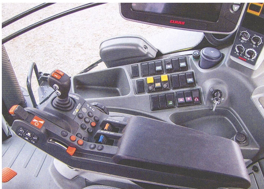
Die Multifunktions-Armlehne der «Cis+»-Ausstattung ist mit neuen Bedienungsmöglichkeiten ausgestattet.
