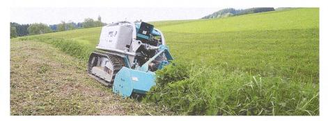
Die Fällraupe «Moritz» des deutschen Forsttechnikspezialisten Pfanzelt hat ein Jahr nach der erstmaligen Präsentation eine Erweiterung erfahren, indem die integrierte Seilwinde in wenigen Minuten und ohne Werkzeug ausgebaut werden kann. Was dann übrig bleibt, ist
