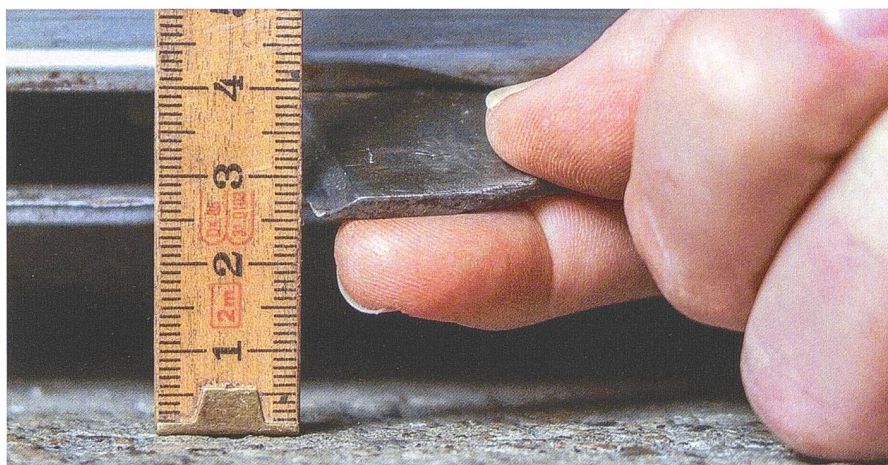
Eine Stoppelhöhe von 6 bis 7 cm bedingt einen Klingenabstand zum Boden von rund 3 cm.
