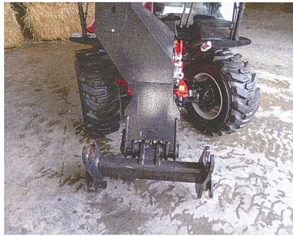
Vorne am Ausleger ist der Aufnahmebereich leicht angewinkelt, sodass die Anbaugeräte zentral positioniert sind.
