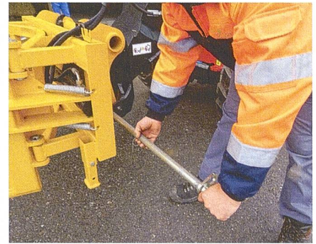
Die Verriegelungswelle muss händisch eingeführt und mit einem Spannstift gesichert werden.
