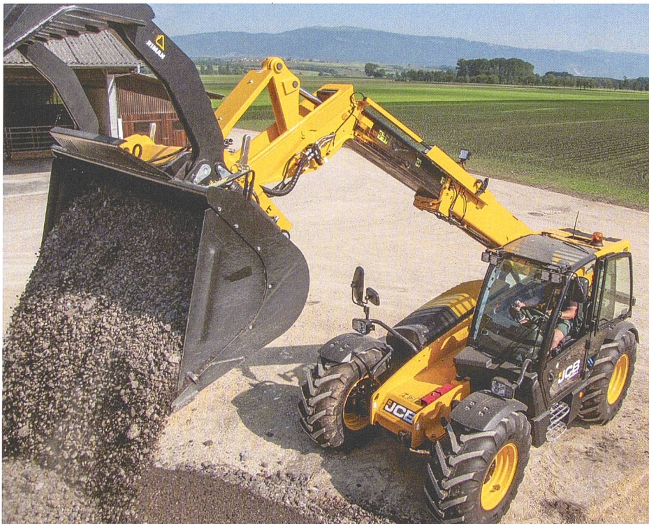
Die Kabine bietet dank grosszügiger Fensterflächen eine gute Sicht auf angehobene Anbaugeräte. Bilder: R. Burkhalter
