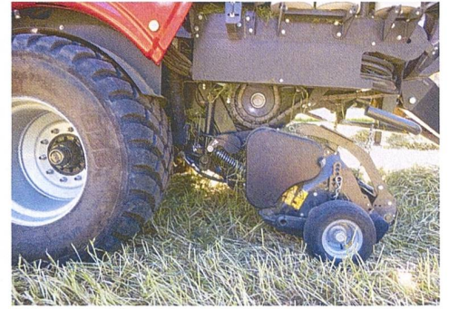
Das 220 cm breite Pickup passt sich den Bodenunebenheiten gut an und nimmt das Futter sauber auf. Nach dem Rotor wird es in die Vor- oder Hauptkammer geleitet.
