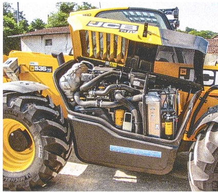
Der Motor wurde speziell für den kompakten Motorraum gebaut, sodass eine gute Sicht nach rechts gewährleistet ist.
