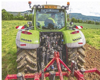
Im Heck können bis zu fünf Steuergeräte geordert werden. Die Hubkraft beträgt 10360 daN.
