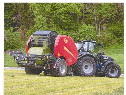
Zur zuverlässigen Ballenübernahme wird der Wickelrahmen mit einer parallelogrammgeführten Aufhängung abgesenkt.
