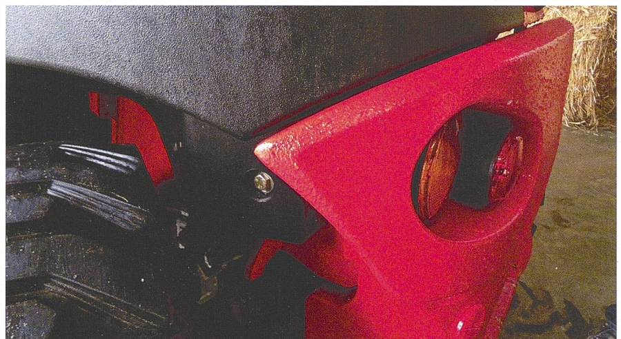
Die Leuchten im Heck sind alle versenkt in der Karosserie angebracht.
