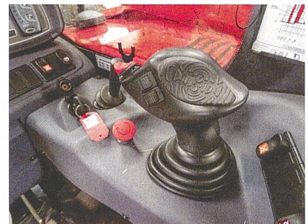
In der Kabine trifft man den bekannten «JSM»-Joystick für die Bedienung des Auslegers, des Getriebes und des dritten Steuerkreises.
