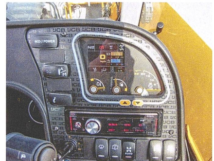
Die Anzeigetafel ist rechts vom Lenkrad angeordnet, weitere Anzeigen befinden sich vor dem Lenkrad. Der Belastungszustand wird im rechten Kabinenholm angezeigt.
