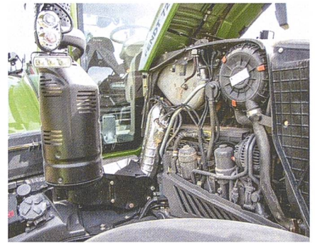
Der neue Partikelfilter wurde unter der Motorhaube angebracht, wodurch diese 4 cm höher ausgefallen ist.
