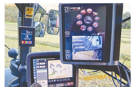
Vicon liefert zur Steuerung das «IsoMatch Tellus»-Terminal (rechts). Die Maschine lässt sich aber auch mit einem traktorinternen Isobus-Terminal bedienen (links).
