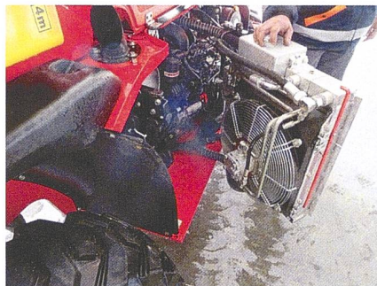
Nach dem Entfernen der Abdeckung lässt sich der Kühler für die Reinigung und den Zugang zu den Motorkomponenten seitlich ausschwenken.
