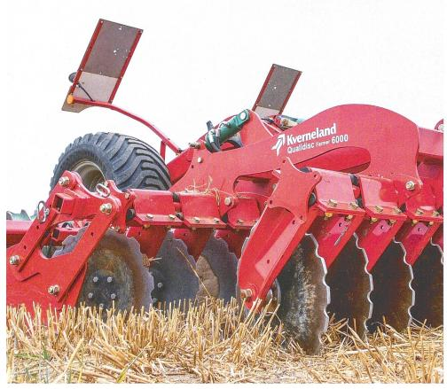
Kurzscheibeneggen beanspruchen etwas weniger Zugkraft. Mit zunehmender Arbeitstiefe nimmt die Wirkung der Rückverfestigung ab und das Stroh wird tiefer eingearbeitet. Bild: Kverneland
