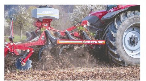
Grubber haben mit zunehmender Arbeitstiefe mehr Einzug, damit erhöht sich der Druck auf den Nachläufer, was letztendlich zu mehr Rollwiderstand und Zugkraftbedarf führt. Bild: R. Hunger
