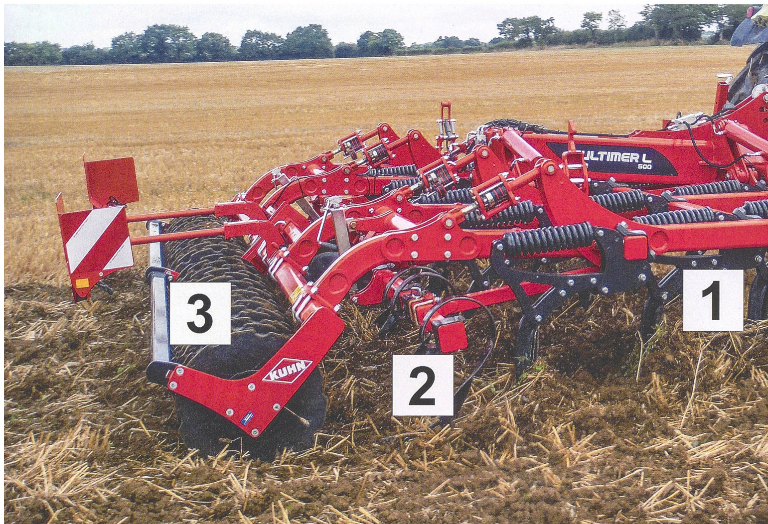
Noch werden hauptsächlich 3 m breite Anbaugrubber gekauft. 1 = Zinkenordnung auf verschiedenen Ebenen. 2 = Einebnungswerkzeuge zum Glätten der Oberfläche. 3 = Nachläufer zur Rückverfestigung. Bild: Kuhn/Hunger
