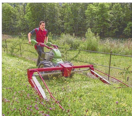
Der «Varea» ist mit einem 14 PS starken Motor von Subaru-Robin und mit hydrostatischem Fährantrieb ausgerüstet.
