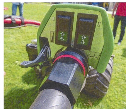
Das Cockpit mit den Steuerungstasten für die Zusatzhydraulik, die von gewissen Anbaugeräten gefordert wird.
