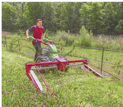
Der «Varea» ist mit einem 14 PS starken Motor von Subaru-Robin und mit hydrostatischem Fahrtrieb ausgerüstet.
