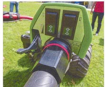
Das Cockpit mit den Steuerungstasten für die Zusatzhydraulik, die von gewissen Anbaugeräten gefordert wird.
