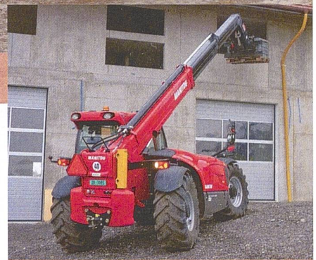
Der Niveaueingleich des MLT 1040 ermöglicht, Material unabhängig vom Gelände horizontal vor eine Gebäudeöffnung zu liefern
