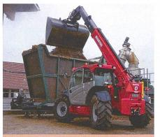
Mit der Leichtgutschaufel schafft der Manitou in 5 bis 6 Fahrten rund 15 m³ Material in die Biogasanlage
