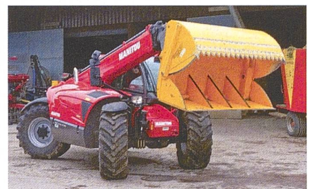
Die Siloschneidschaufel passt auf die Manitou-Werkzeugaufnahme und verriegelt hydraulisch
