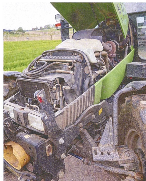
Gute Zugänglichkeit zum Motor, die Vorderachse hat automatische Allradzuschaltung.
