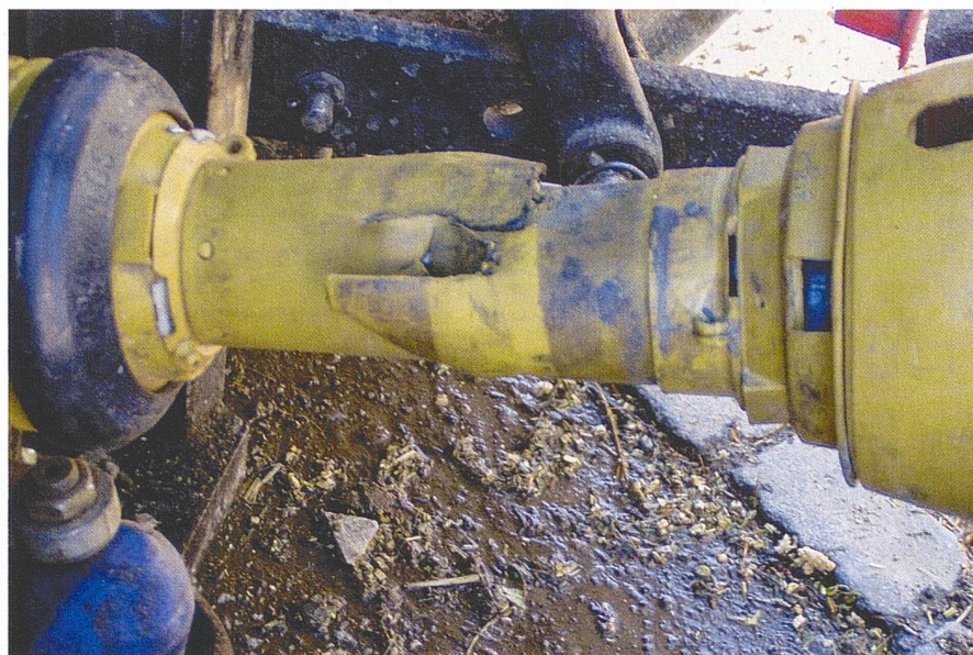
Es sind die kurzen Gelenkwellen an schweren Maschinen, die am ehesten noch Probleme bereiten.
