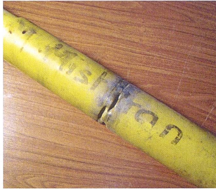
Der Anfang vom Ende – typisches Schadbild einer zu engen beziehungsweise nicht gelösten Haltekette.
