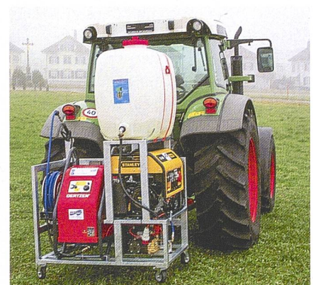
Die Dreipunktversion des Bachmann-Blackenvernichters ist auf einem Metallrahmen aufgebaut. Das Heisswassergerät (rot) kann für den Einsatz im Stall demontiert werden.
