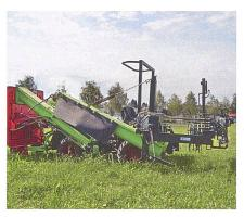
Diese Version des «Wuzi»-Blackenausreissers ist mit einem Bunker für das Abführen der ausgerissenen Wurzelstöcke ausgerüstet.
