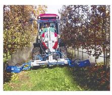
Die fahrende Unkrautbekämpfung mit Dampf, hier in einer Obstbaukultur eingesetzt, benötigt hohe thermische Leistungen.
