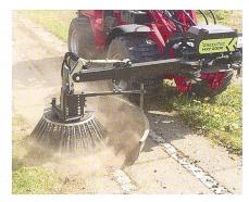
Für die mechanische Unkrautbekämpfung mit Bürsten gibt es mittlerweile unzählige Anbaugeräte für Hoflader, Einachser und andere Trägerfahrzeuge.
