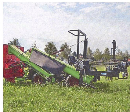
Diese Version des «Wuzi»-Blackenausreissers ist mit einem Bunker für das Abführen der ausgerissenen Wurzelstöcke ausgerüstet.
