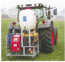
Die Dreipunktversion des Bachmann-Blackenvernichters ist auf einem Metallrahmen aufgebaut. Das Heisswassergerät (rot) kann für den Einsatz im Stall demontiert werden.
