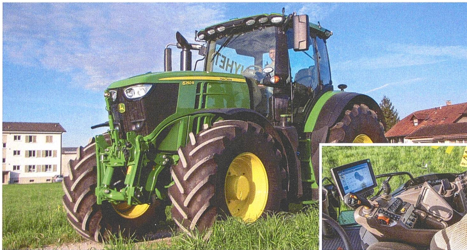
Mit den neuen «6R»-Modellen führt John Deere ein modifiziertes Bedienkonzept mit neu konzipiertem Multifunktionsgriff ein. Bilder: R. Burkhalter
