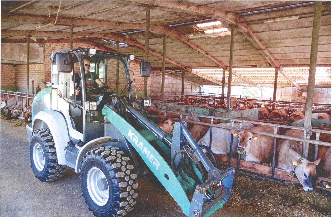
Die geringe Lautstärke, vor allem aber der abgasfreie Betrieb des «KL 25.5e» ist gerade bei der Arbeit innerhalb von Gebäuden ein wichtiger Pluspunkt für Mensch und Tier. Bilder: R. Engeler
