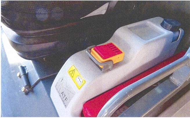
Links vom Fahrersitz ist der bei Elektromaschinen bekannte Knopf für das Ein- und Ausschalten des Laders positioniert.
