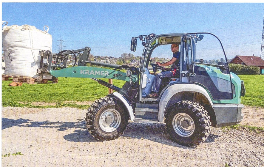
Kein Problem mit Lasten bis 1750 kg: der «KL 25.5e» im praktischen Einsatz mit Stapelvorrichtung.
