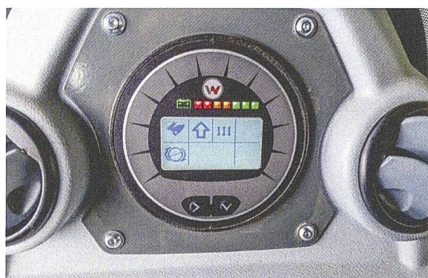
Der aktuelle Ladezustand der Batterie wird mittels Leuchten (rot-orange-grün) am Armaturenbrett angezeigt.
