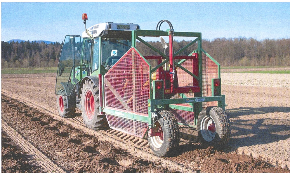
Die elektronische Steuerung des Erdlochbohrers steuert den Traktor automatisch von einem Bohrloch zum nächsten.
