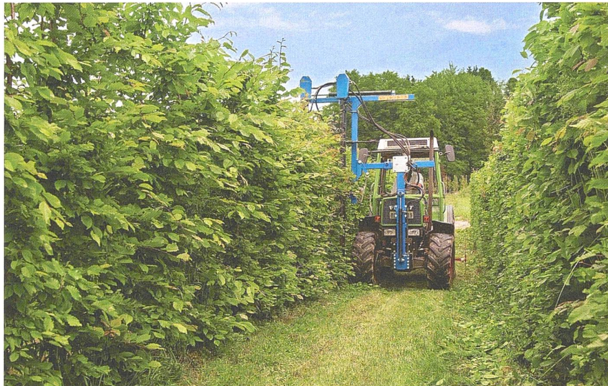
Beim Zurückschneiden der Fertighecken reduziert das RTK-System den Arbeitskraftbedarf deutlich.
