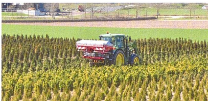
Der Düngerstreuer kann für höhere Kulturen dank Hubmast angehoben werden.
