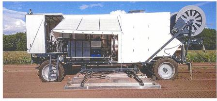
Bereits sind vollautomatische Systeme im Einsatz, die mit heissem Dampf den Boden unter der Haube im «Stop/Go-Verfahren» sterilisieren. Bild: Möschle Seifert
