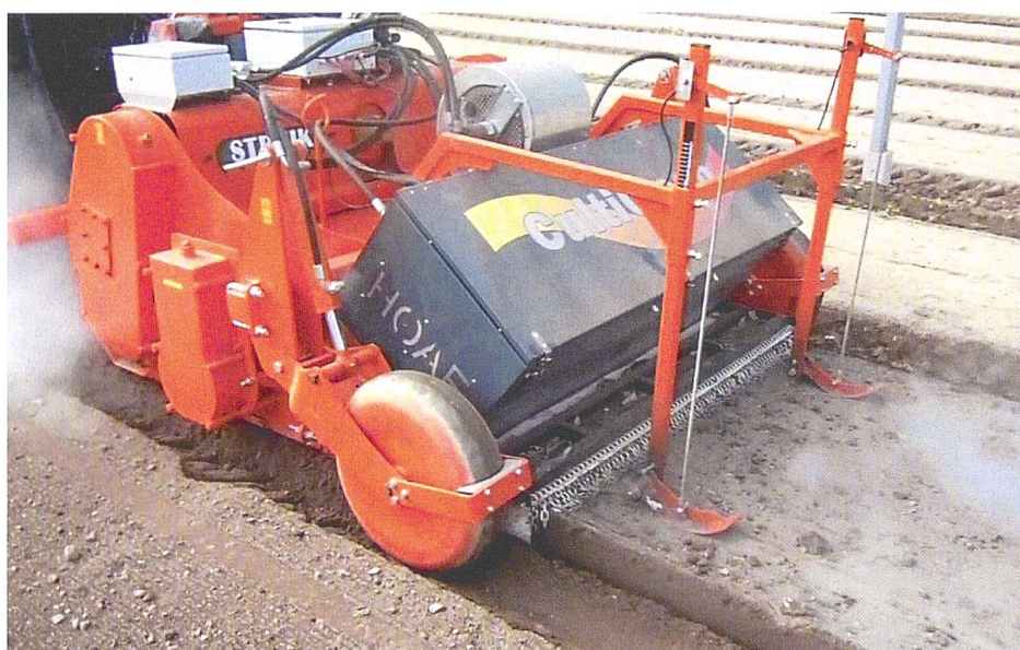
«CultiClean» ist ein Verfahren aus den Niederlanden. Der Erdstrom von zwei gegenläufigen Fräsrötoren fliesst durch eine heisse Gasflamme. Bild: Struik NL
