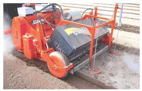
«CultiClean» ist ein Verfahren aus den Niederlanden. Der Erdstrom von zwei gegenläufigen Fräsrotoren fliesst durch eine heisse Gasflamme. Bild: Struik NL
