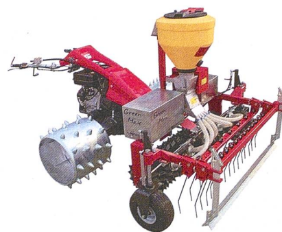
Der Südtiroler Unternehmer Seeber baut ein mit Sätechnik ausgestattetes Pflegegerät für Hang- und Berglagen. Bild: Seeber
