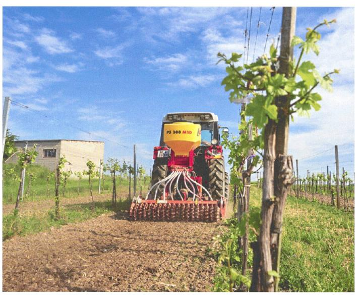
Pneumatische Sägeräte eignen sich auch speziell gut für den Einsatz in Spezialkulturen. Bild: APV
