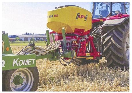
Gleiches Prinzip – aber mehr Nutzinhalt und für grössere Arbeitsbreiten. Profigerät mit Geräteträger für gezogene Bodenbearbeitung. Bild: APV
