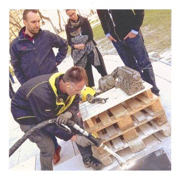
Demonstration des Trockeneis-Strahlverfahrens (Ice-Blaster).
