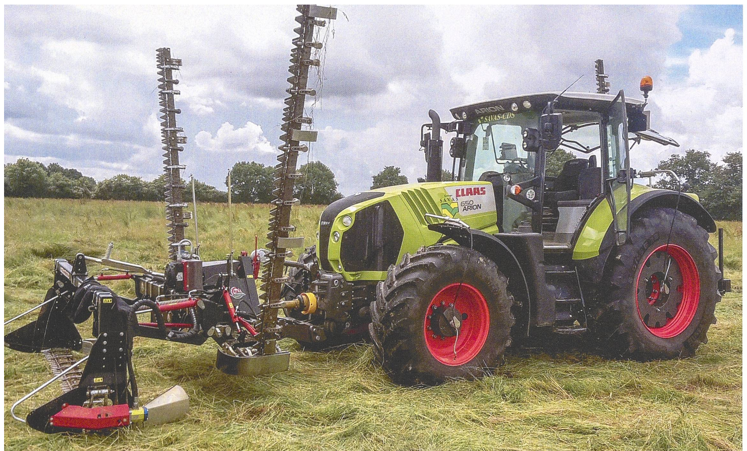
Anstelle einer Front-Heck-Kombination gibt es Doppelmessermähwerke auch für den ausschliesslichen Front- oder Heckanbau – letztere mit einer Rückfahrvorrichtung. Bild: BB-Umwelttechnik
