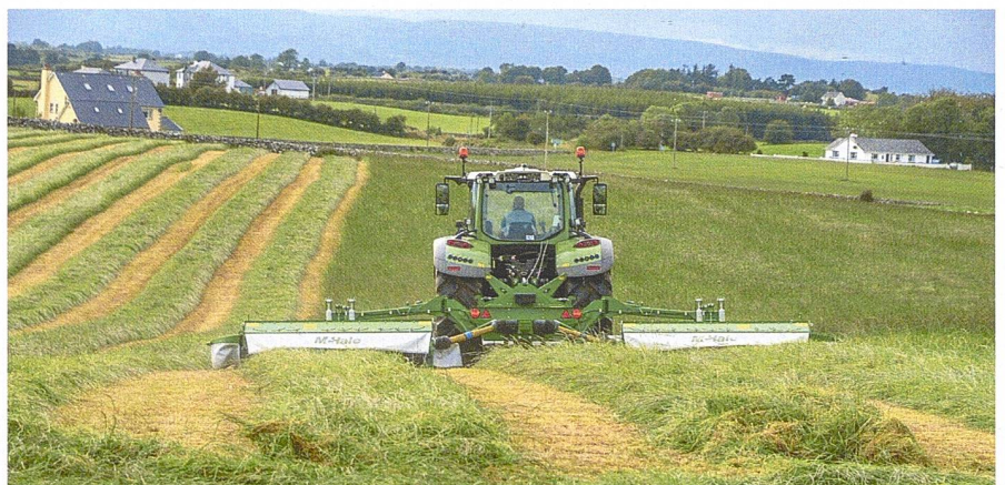
Der Leistungsbedarf für Front-Heck-Scheibenmähwerkombinationen ist relativ hoch, es kann aber entsprechend schnell gefahren werden (bis 15 km/h). Bild: McHale
