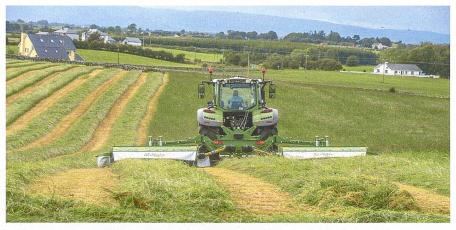
Der Leistungsbedarf für Front-Heck-Scheibenmähwerkkombinationen ist relativ hoch, es kann aber entsprechend schnell gefahren werden (bis 15 km/h). Bild: McHale
