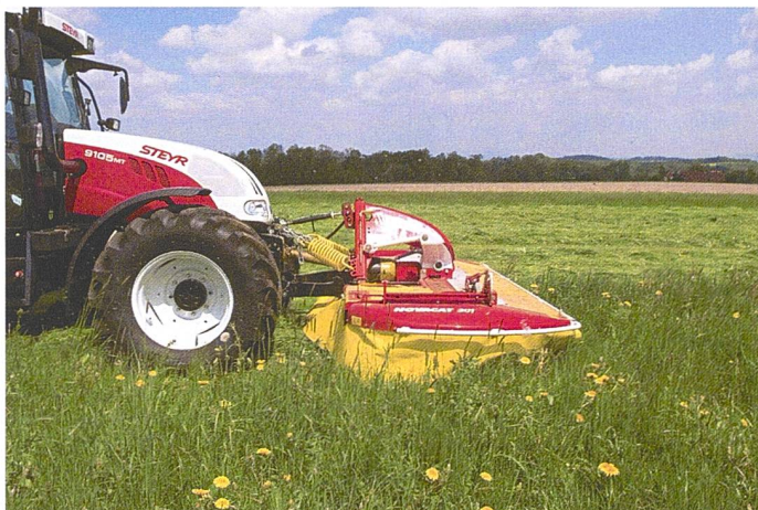
Auch ein Traktor der mittleren Leistungsklasse mit einem Frontmähwerk kann in vielen Fällen den maximalen vorderen Überhang nicht einhalten. Bild: Pöttinger
