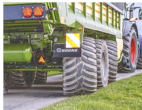
Mit dem Hundegang kann auch einmal vom Fahrsilorand weggelenkt werden, dazu wird die mittlere Achse leicht angehoben.
