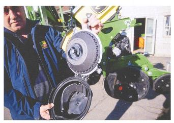
Die Löcher in der schüsselförmigen Lochscheibe befinden sich in einer Kerbe, was das Festhalten der Körner unterstützt.
