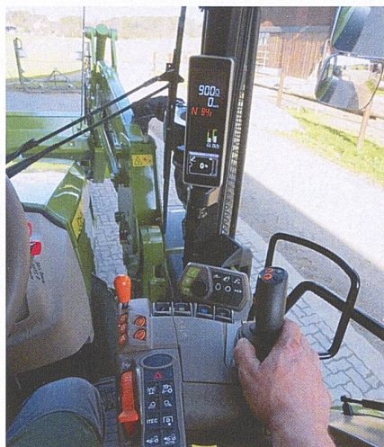
Die Armlehne ist mit den wichtigen Bedienelementen versehen. Am A-Holm ist das neue Display. Es ersetzt das Armaturenbrett.
