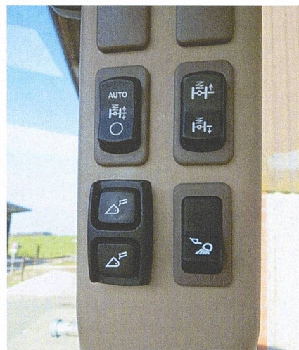
Am B-Holm sind die Bedienteile für Vorderachsfederung, Geräteverriegelung und Scheinwerfer am Frontlader abgebracht.
