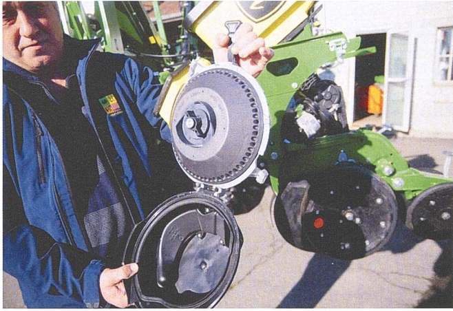
Die Löcher in der schüsselförmigen Lochscheibe befinden sich in einer Kerbe, was das Festhalten der Körner unterstützt.
