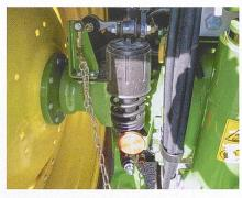
Eine mechanische Kabinenfederung sorgt für zusätzlichen Fahrkomfort.
