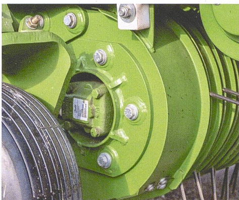
Kompakt gebaut – der im Rundrohr integrierte hydraulische Pick-up-Antrieb.
