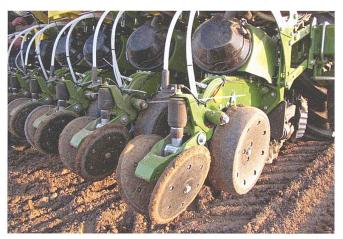
Der Druck auf die Andruckrollen lässt sich pneumatisch regeln. Man sieht zudem die Schläuche für Flüssigdünger und Schneckenkörner.
