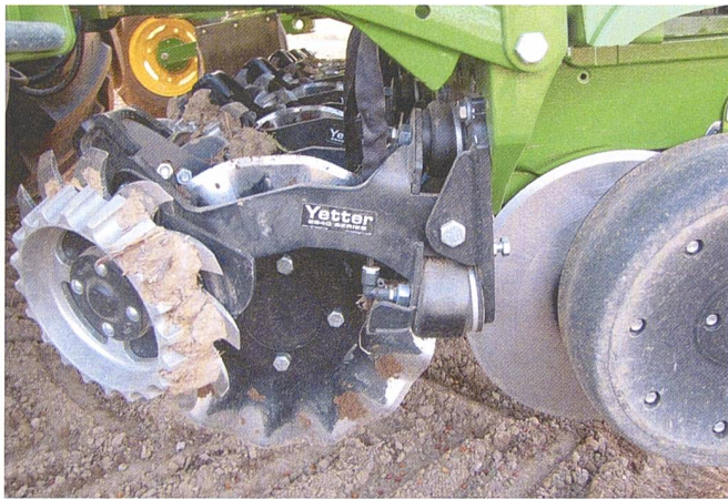
Die Sternräumer von Yetter lassen sich über pneumatische Bälge in der Intensität verstellen und regeln.
