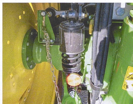
Eine mechanische Kabinenfederung sorgt für zusätzlichen Fahrkomfort.
