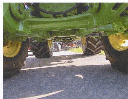
Durch den neuen Rahmen mit eingegossener Ölwanne ergibt sich ein tiefer Schwerpunkt.
