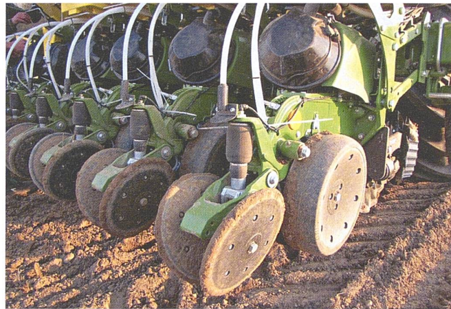
Der Druck auf die Andruckrollen lässt sich pneumatisch regeln. Man sieht zudem die Schläuche für Flüssigdünger und Schneckenkörner.
