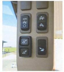
Am B-Holm sind die Bedienteile für Vorderachsfederung, Geräteverriegelung und Scheinwerfer am Frontlader abgebracht.
