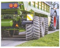
Mit dem Hundegang kann auch einmal vom Fahrsilorand weggelenkt werden, dazu wird die mittlere Achse leicht angehoben.
