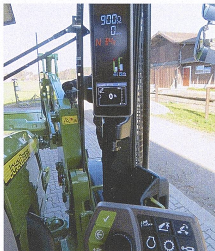
Über die Bedieneinheit vorne auf der Armlehne kann man sämtliche Einstellungen vornehmen.
