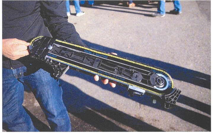
Die Bürstenbänder sind in einer Kunststoffkassette untergebracht, die sich dank Klickverschluss werkzeuglos demontieren und öffnen lässt.
