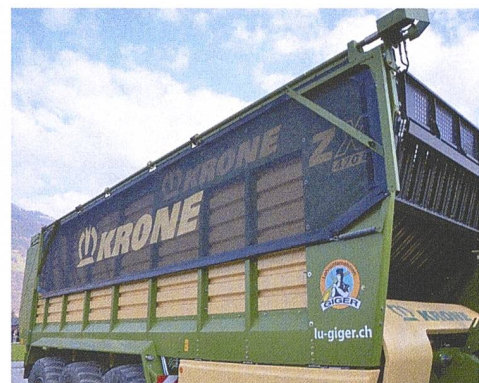
Damit drauf bleibt was drin ist – dank oberer Abdeckung wird die jeweilige Ladung auch gesichert.
