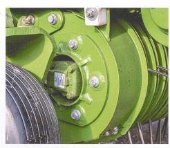
Kompakt gebaut – der im Rundrohr integrierte hydraulische Pick-up-Antrieb.
