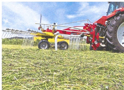
Ursache 3: In der Absicht, auch den letzten Halm zu erreichen, werden Kreiselschwader oft zu tief eingestellt. Bild: Pöttinger
