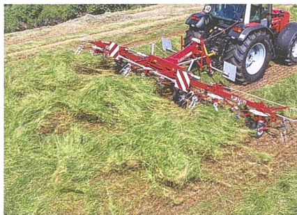
Ursache 2: Trotz zunehmender Trocknung wird beim zweiten Durchgang mit zu hoher Drehzahl gefahren. Bild: JF-Stoll
