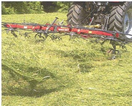
Mit der richtigen Streuwinkeleinstellung wird erreicht, dass alles Mähgut aufgenommen und locker wieder abgelegt wird.
