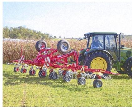
Damit auch kleinere Traktoren zum Zetten eingesetzt werden können, gibt es bei vielen Marken ein hochklappbares Fahrwerk. Bild: R. Hunger
