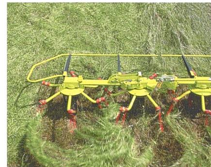
Durch tangentiale Gestaltung der Zinkenarme wird der Kreiselheuer für die Futteraufnahme und -ablage optimiert.
