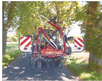
Bei 3-Punkt-Anbaumaschinen müssen verschiedene Tricks angewendet werden, damit die Transportmasse eingehalten werden. Bild: Kverneland
