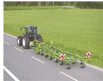
Schliesslich gibt es bei einigen Herstellern auch die Möglichkeit, grosse Kreiselheuer ohne zusätzliches Fahrwerk längs einschwenken und so zu transportieren. Bild: Krone
