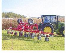
Damit auch kleinere Traktoren zum Zetten eingesetzt werden können, gibt es bei vielen Marken ein hochklappbares Fahrwerk. Bild: R. Hunger
