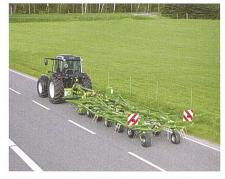
Schliesslich gibt es bei einigen Herstellern auch die Möglichkeit, grosse Kreiselheuer ohne zusätzliches Fahrwerk längs einzuschwenken und so zu transportieren. Bild: Krone
