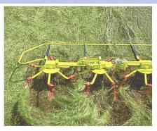
Durch tangentiale Gestaltung der Zinkenarme wird der Kreiselheuer für die Futteraufnahme und -ablage optimiert.
