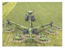
Der sechsteilige Kreiselschwader ist eine Profimaschine, die auch dem Feldhäcksler Paroli bietet. Bild: Krone
