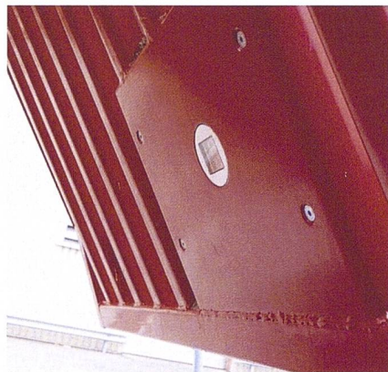
Der für den «Rapide» von Schuitemaker erhältliche NIR-Sensor misst die Feuchtigkeit im Ladegut und ermöglicht in Kombination mit der Wiegeeinrichtung ein Erfassen des geladenen TS-Gehalts.
