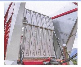
Die schwenkbare Multifunktionsstirnwand wurde von Lely erst für die grösseren «Tigo»-Baureihen entwickelt, ist aber heute auch im mittleren Segment erhältlich. Sie hilft beim Laden, Entladen und schafft zusätzlichen Raum.
