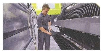
Beim neusten «Cargos» von Claas lassen sich die beidseitig verwendbaren Spezialmesser dank absenkbarem Kratzboden bequem in aufrechter Haltung wechseln.
