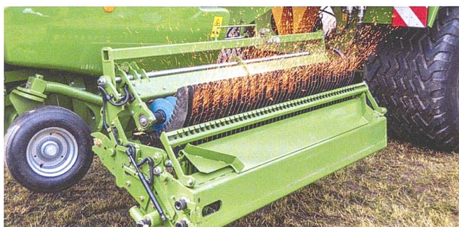
Die Messerschleifeinrichtung «Speed Sharp» von Krone arbeitet mit Fächerscheiben und ermöglicht ein automatisches Nachschärfen aller Messer in rund zwei Minuten.
