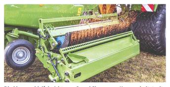
Die Messerschleifeinrichtung «Speed Sharp» von Krone arbeitet mit Fächerscheiben und ermöglicht ein automatisches Nachschärfen aller Messer in rund zwei Minuten.
