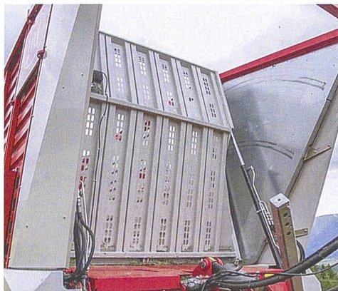
Die schwenkbare Multifunktionsstirnwand wurde von Lely erst für die grösseren «Tigo»-Baureihen entwickelt, ist aber heute auch im mittleren Segment erhältlich. Sie hilft beim Laden, Entladen und schafft zusätzlichen Raum.
