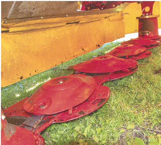
Die geklemmten Mähklingen und der flache Balken lieferten unter allen Bedingungen eine saubere Mäharbeit.
