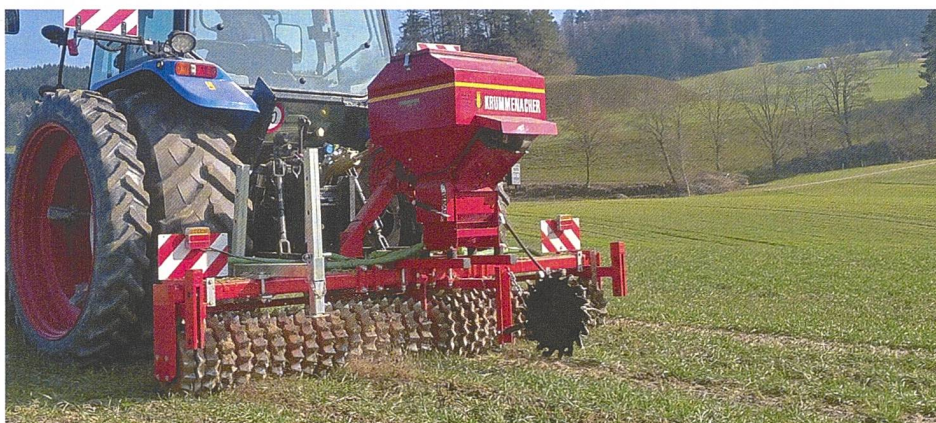
Die Guttler-Prismenwalze regt die Bestockung von Getreide an.
