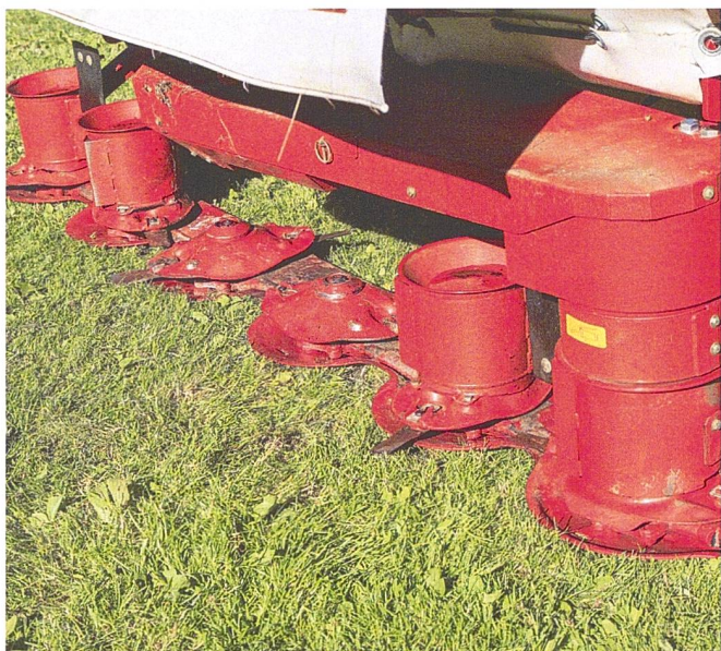
Die trommelartigen Mähscheibenerhöhungen sorgen für eine saubere Schwadbildung.
