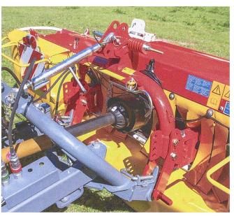
Der Anbaubock ist für Kat. I und II ausgelegt und mit serienmässiger Anfahrsicherung ausgestattet.
