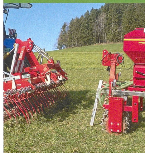
Die zwei kompletten 3-Punkt-Geräte lassen sich problemlos entkoppeln und dann Mist ins Grünland einarbeiten.
