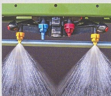
kann. Für einen Düsenwechsel muss man nicht mehr absteigen, sondern kann zwischen vier Düsen bequem in der Kabine umschalten.
