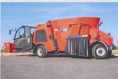
Maschinen mit geringer Bauhöhe auf den Markt gebracht. Die Modelle mit 12, 14 und 15 m<sup>3</sup> («Accexx») bzw. 12, 14, 15 und 17 m<sup>3</sup> («Power») verfügen über eine hintere Lenkachse, was einen kleinen Wendekreis zur Folge hat. Der zwischen beiden Achsen angeordnete Behälter ruht auf einem Fahrgestell. Dadurch konnte die Behälterhöhe gering gehalten werden. Bei der Version mit 15 m<sup>3</sup> Volumen liegt die Gesamthöhe der Maschine unter 3,00 m.
