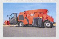
Maschinen mit geringer Bauhöhe auf den Markt gebracht. Die Modelle mit 12, 14 und 15 m³ («Acccess») bzw. 12, 14, 15 und 17 m³ («Power») verfügen über eine hintere Lenkachse, was einen kleinen Wendekreis zur Folge hat. Der zwischen beiden Achsen angeordnete Behälter ruht auf einem Fahrgestell. Dadurch konnte die Behälterhöhe gering gehalten werden. Bei der Version mit 15 m³ Volumen liegt die Gesamthöhe der Maschine unter 3,00 m.
