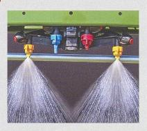
kann. Für einen Düsenwechsel muss man nicht mehr absteigen, sondern kann zwischen vier Düsen bequem in der Kabine umschalten.
