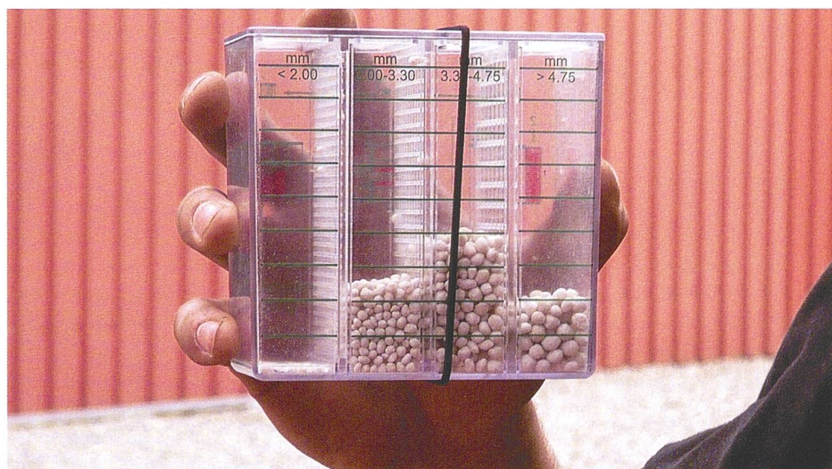
Je homogener die Korngrösse, je besser gestaltet sich die Ausbringqualität.
