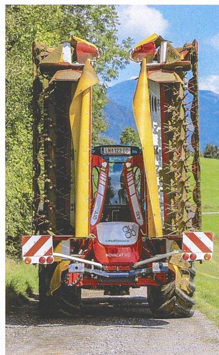
Mit dem schmalen Dreipunktbock ist das Mähwerk beim Transport nur 2,70m breit.
