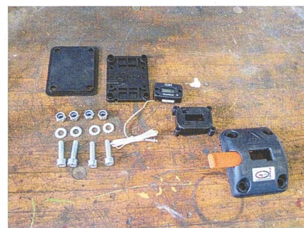
Das Gerät ist mehrschalig aufgebaut, im Inneren befindet sich mit dem eigentlichen Zähler das Herzstück des Geräts.
