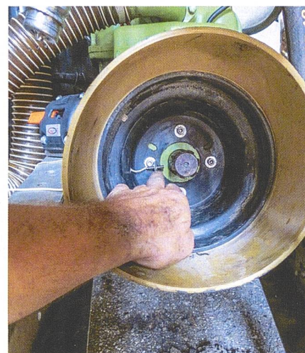
Mit einem Abstand von minimal 3 mm erfasst der Sensor die Signale vom Impulsgeber (Magnet), der sich auf dem drehenden Teil befindet.
