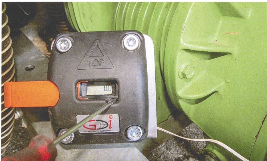
Das Display in der Grösse von 5 auf 2 cm ist gut ablesbar. Ein Schieber schützt die Anzeige vor Stössen, Schmutz und Feuchtigkeit. Bilder: M. Abderhalden
