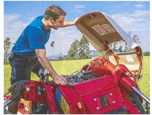
Unter der Kunststoffabdeckung befinden sich der Ventilblock mit Notbetätigungen und Hinweise zur Wartung.
