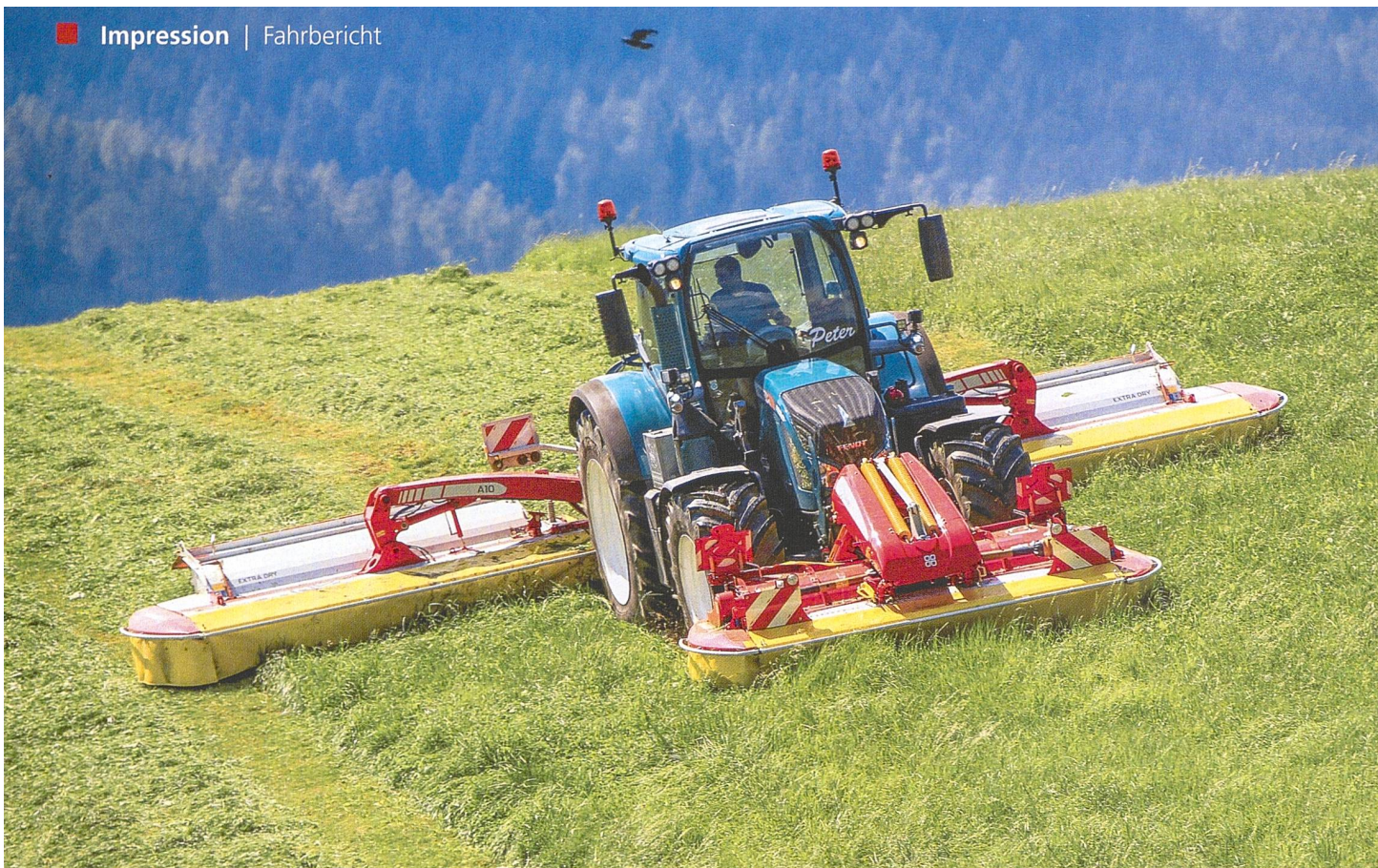
Für die maximale Arbeitsbreite von 10m braucht man beim «Novacat A10» einen 3,5m breiten Frontmäher. Bilder: A. und C. Leitner
