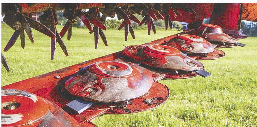
Der bewährte, hydraulisch entlastete «Novacat»-Mähbalken mit seiner glatten Oberfläche und den geklemmten Klingen mäht stets sauber.
