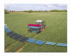
schlossen, bis schliesslich nur noch die beiden mittleren Teilbreiten offen bleiben. Die teilflächenspezifische Düngung wird mit einer separaten, GPS-gesteuerten Mengenverstellung rechts/links realisiert. Vom einfachen Wiegesystem über das halbmondförmige Streubild bis zur separaten Mengenverstellung links/rechts wird alles über das eigene «Quarz 800» Terminal gesteuert. Der Einsatz des Düngerstreuers ist grundsätzlich an Traktoren sowohl mit und als auch ohne Isobus möglich.
