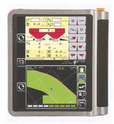
bild. Damit Über- und Unterdosierungen am Vorgewende verhindert werden, wird der Streuer automatisch ein- und ausgeschaltet, sobald man das Vorgewende erreicht.
