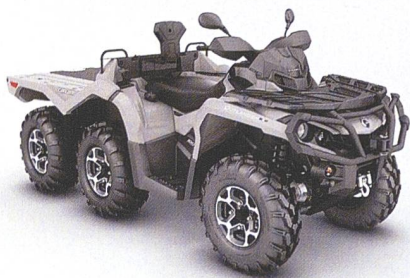
Unter den ATV weisen die 6×6-Modelle wie dieser «Outlander» von Can-Am deutlich höhere Nutz- und Anhängelasten auf als herkömmliche Vierradmodelle.
