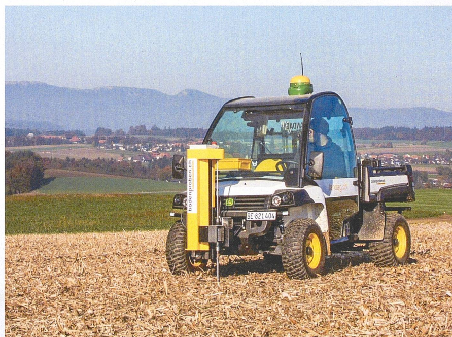
Dieser «Gator XUV855D» von John Deere wird zum Stechen von Bodenproben und zum Vermessen von Feldern eingesetzt. Die Arbeitshydraulik wird über einen Aufbaumotor
