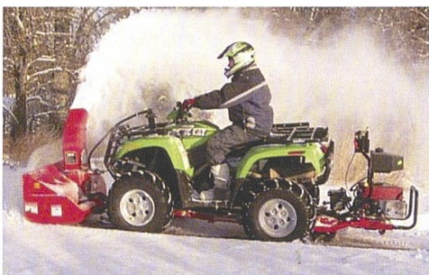
Der Antrieb von Anbaugeräten mit hohem Leistungsbedarf ist meist nur mit einem Aufbaumotor möglich. Bei Quads führt dies schnell zum Überschreiten der Nutzlast.
