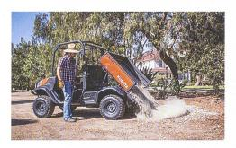
Das Modell «RTV 900» von Kubota ist als eines der wenigen auf dem Markt mit einem hydrostatischen Getriebe ausgestattet.
