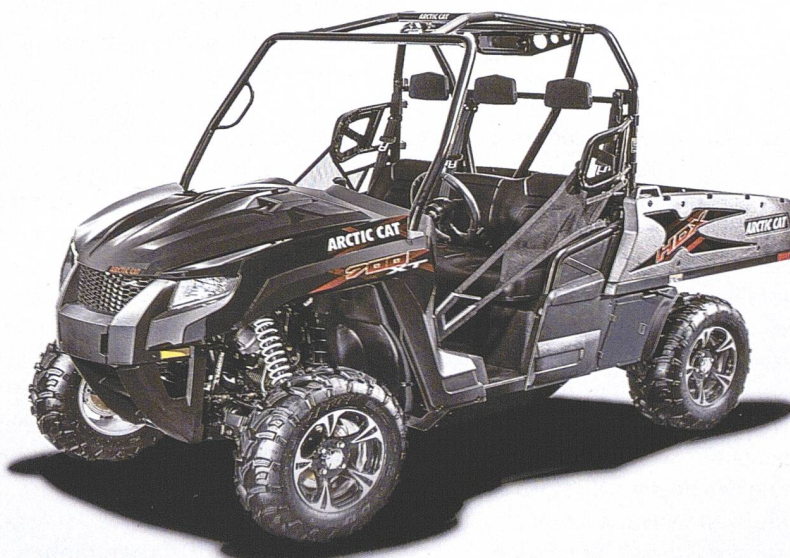
Die «side-by-side»-Baureihe «Prowler» von Arctic Cat soll dank einer elektronisch schaltbaren Differenzialsperre auf der Vorderachse eine besonders gute Traktion erzielen.
